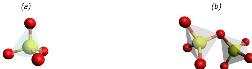
Figure 1.9 : (a) Unité SiO<sub>4</sub> tétraédrique à la base des structures en silice ; (b) Oxygène « pontant » entre deux unités tétraédriques (*jaune* : atome de Silicium ; *rouge* : atome d'Oxygène).
