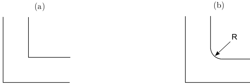
FIGURE 3.15 – Mise en œuvre d'un rayon de courbure : (a) configuration initiale; (b) configuration avec rayon de courbure.
