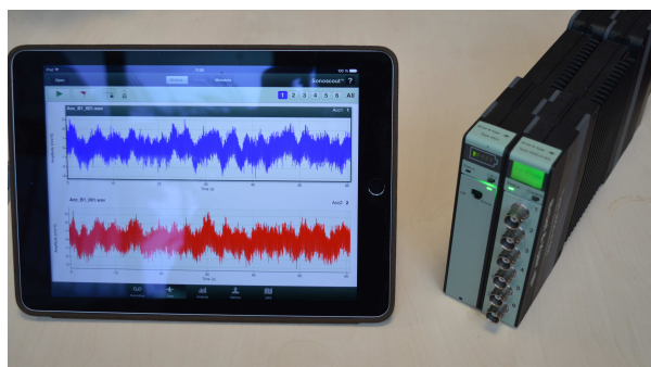
FIGURE 4.3 – Frontal d'acquisition B&K Lan XI 6/0 et iPad avec l'application Sonoscout connectés en wifi.
