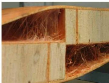
Figure IV-10 : Délaminage peau/cœur suite à une rupture en cisaillement de l'âme
