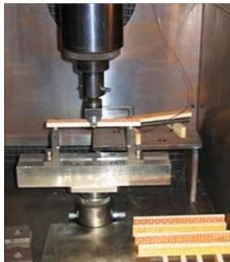
Figure IV-19 : Eprouvette testée en flexion 3 points
