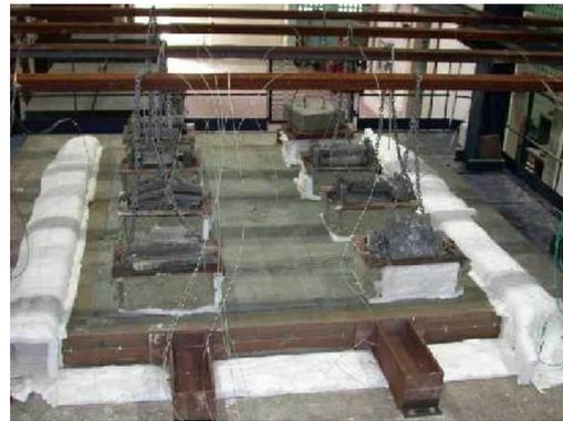
Figure V-7 : Application de la charge par des masses
