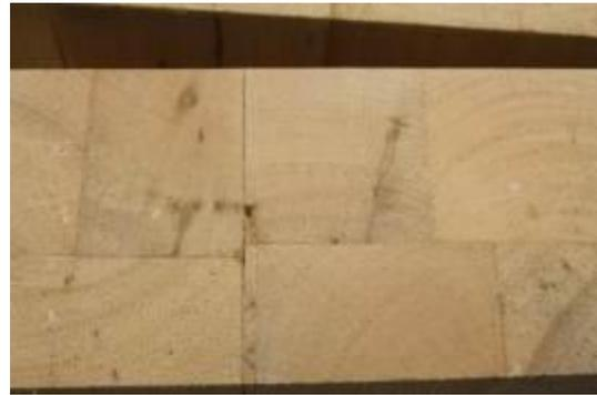
Figure I-4: Disparité de masse volumique des blocs de balsa
