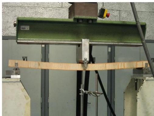
Figure IV-7 : Essai de flexion trois points sur sandwich
