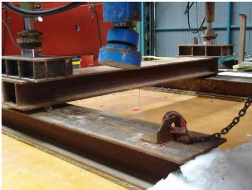
Figure V-6: Application de la charge via des poutres
