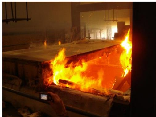
Figure IV-1 : Effondrement d'un pont en matériau combustible (Laboratoire d'Essai au Feu, Liège)
