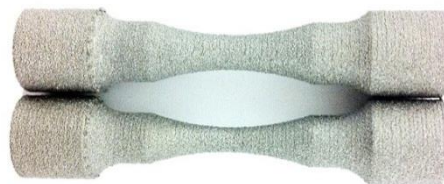
Figure II-2: Photos d'éprouvettes de fatigue à grand nombre de cycles en titane Ti-6Al-4V, brutes de fabrication
