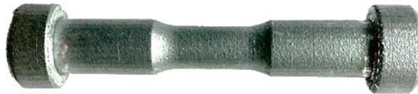
Figure II-3 : Photo d'une éprouvette de fatigue oligocyclique en titane Ti-6Al-4V, brute de fabrication
