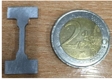
Figure II-8: Photo d'une éprouvette de traction in situ en aluminium AlSi7Mg0,6 après usinage
