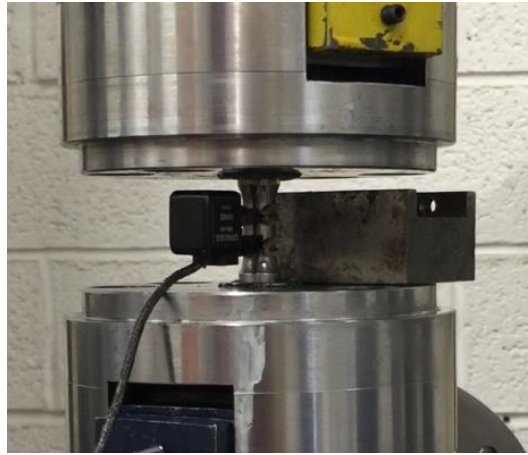
Figure II-16: Photo du montage d'une éprouvette de fatigue oligocyclique
