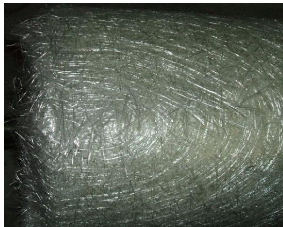
Figure 1-4: Mat en fibres de verre
