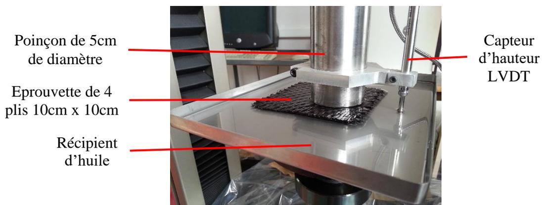
Figure 4-2 : Mesure de compressibilité de préforme lubrifiée
