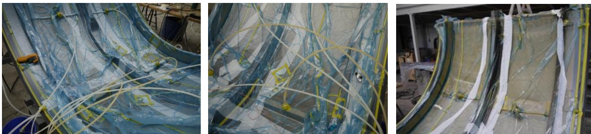
Figure 5-27: Infusion du démonstrateur
