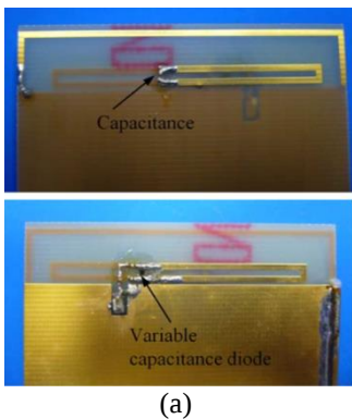
Figure I.46: Antenne reconfigurable en fréquence - (a) Structure, (b) Coefficient de réflexion pour la bande LTE 700/GSM, (c) Coefficient de réflexion pour la bande LTE 2600
