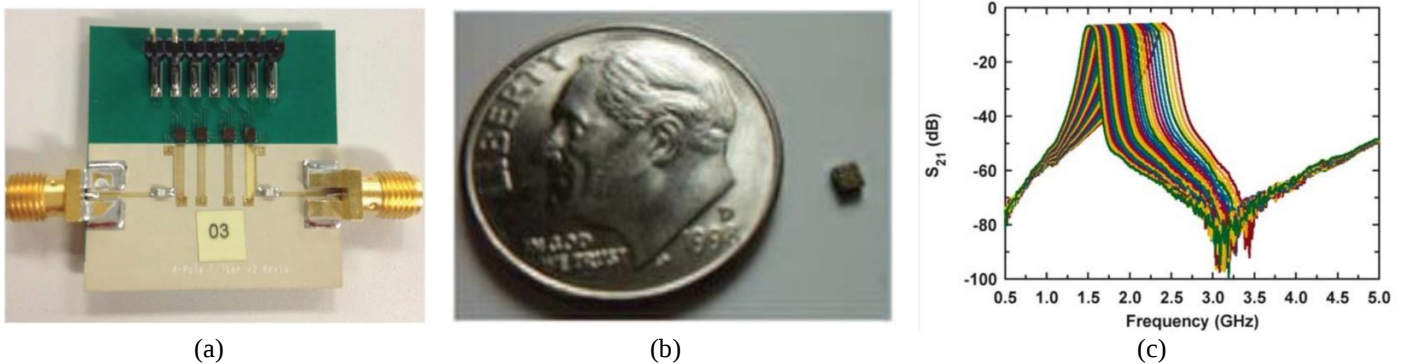
Figure I.22: (a) Photographie du filtre, (b) Photographie d'une capacité variable MEMS, (c) Performances en fréquence du filtre
