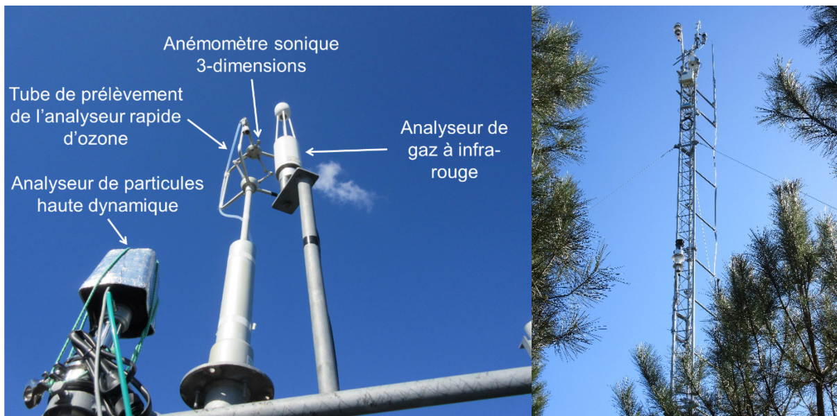
Figure 3-11 : Photos du dispositif expérimental de mesure des flux turbulents.
