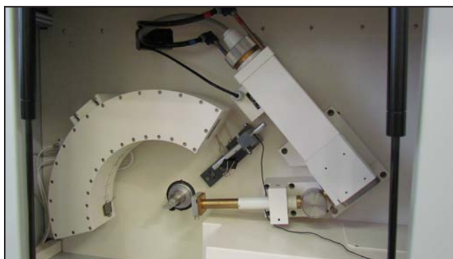
Fig. 21 : Détecteur, tube et source des rayons X du diffractomètre (D-RX).
