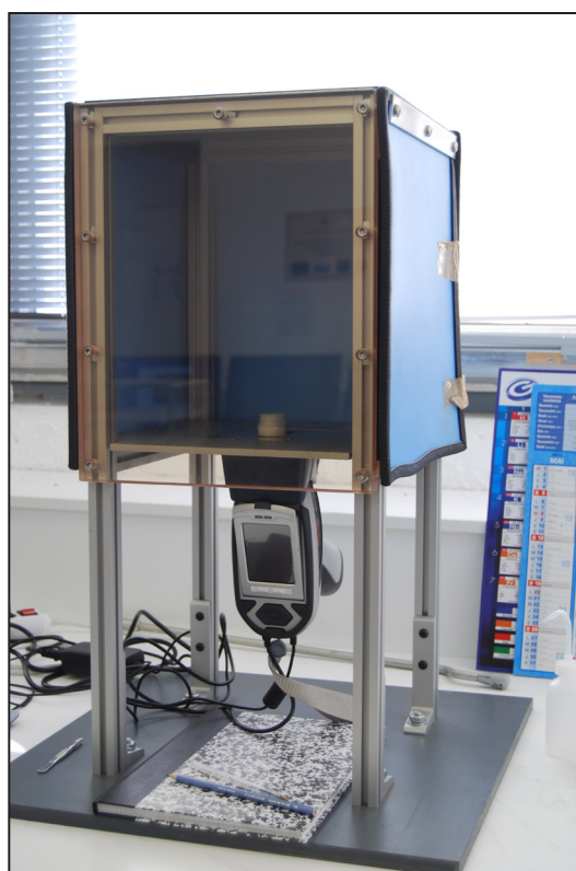
Fig. 22 : Spectromètre portable de fluorescence des rayons X et sa chambre de confinement (P-XRF).
