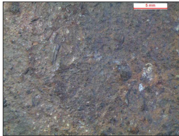
Fig. 62 : Macrographie de la surface interne d'une poterie à inclusions talqueuses. On observe à droite de l'image une gerbe verticale et blanche de talc.
