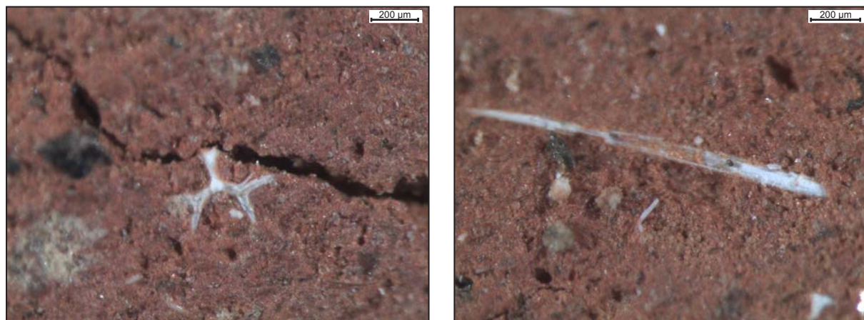
Fig. 167 : Macrographies d'inclusions de spicule dans la pâte de la céramique, visibles en surface externe et interne.
