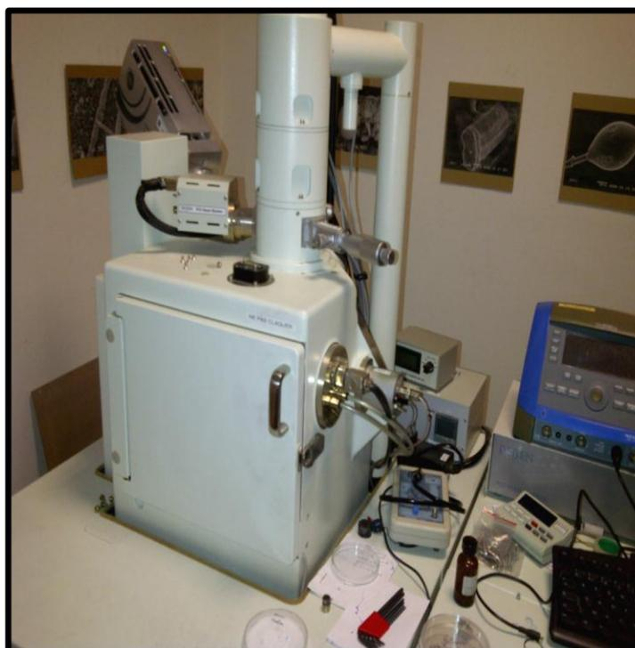
**Figure II-10:** Microscope électronique à balayage de Jeol JSM-6031.
