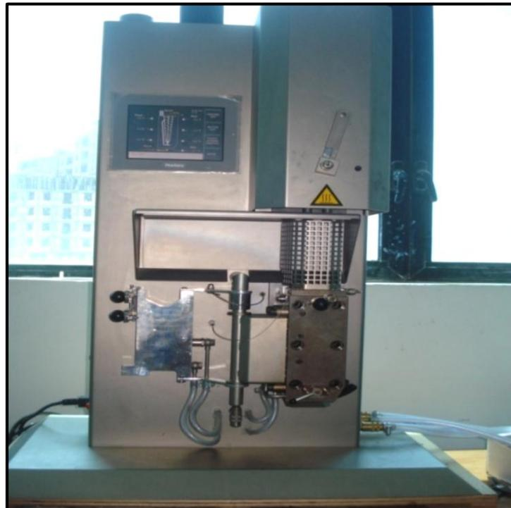
**Figure II-6:** Mini-extrudeuse de marque Micro Compounder DSM Xplore Modèle 2005.
