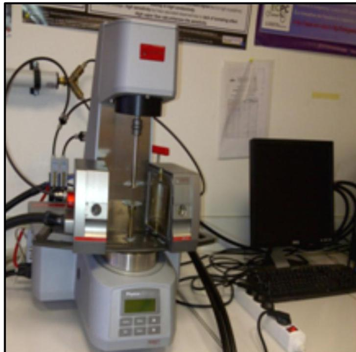
**Figure II-9:** Rhéomètre Anton Paar MCR 301.
