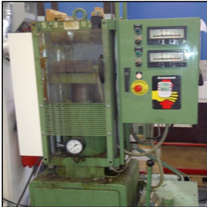
**Figure II-7:** Presse hydraulique de type Daraggon.
