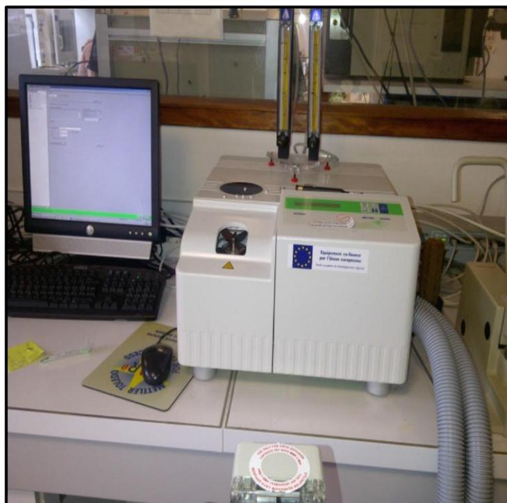
**Figure II-11:** Calorimètre différentiel à balayage METTLER TOLEDO DSC 822<sup>e</sup>.
