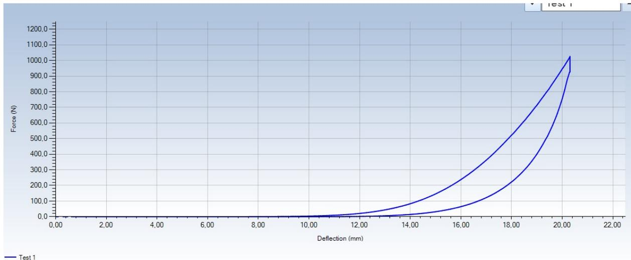
Figure I-15 : Courbe de compressibilité du denim (source : Lectra).
