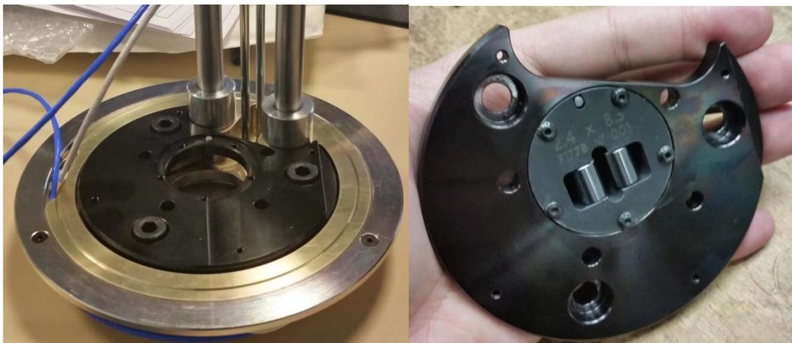
Figure II-10 : Dynamomètre fermé et porte galet intégré.
