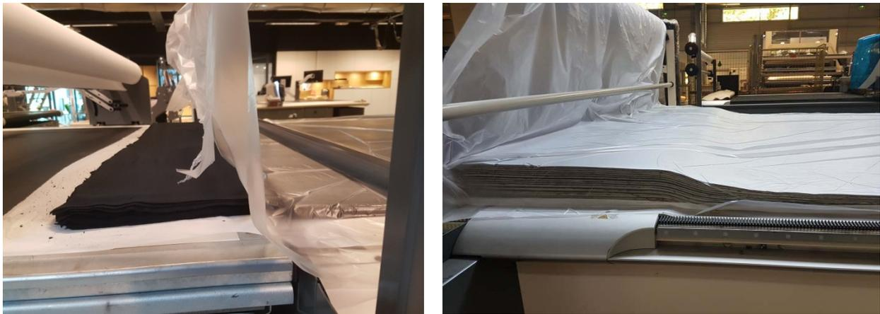
Figure I-14 : Avance du tissu sur la table de coupe et vide d'air.
