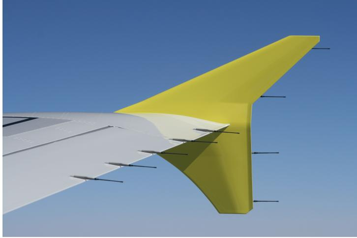
FIGURE 1.4 – Winglet d'un airbus A319.
