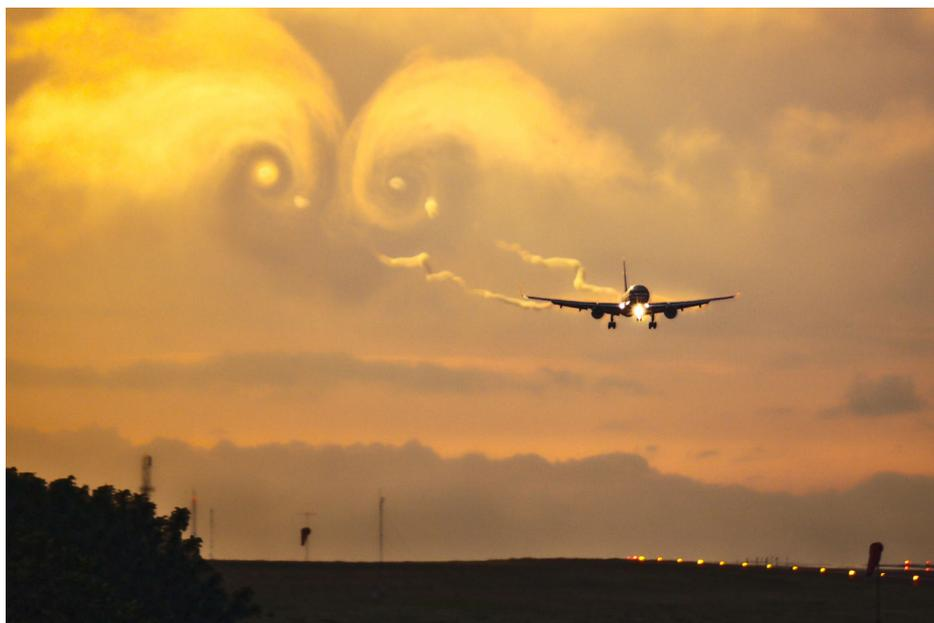
FIGURE 1.1 – Tourbillons de sillage d'un Boeing 757 en phase d'atterrissage (source : <https://www.flickr.com/photos/44073224@N04/>)
