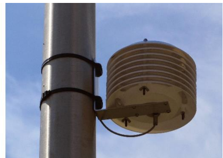
Figure 31 : Photo d'un TinyTag et de l'installation sur site
