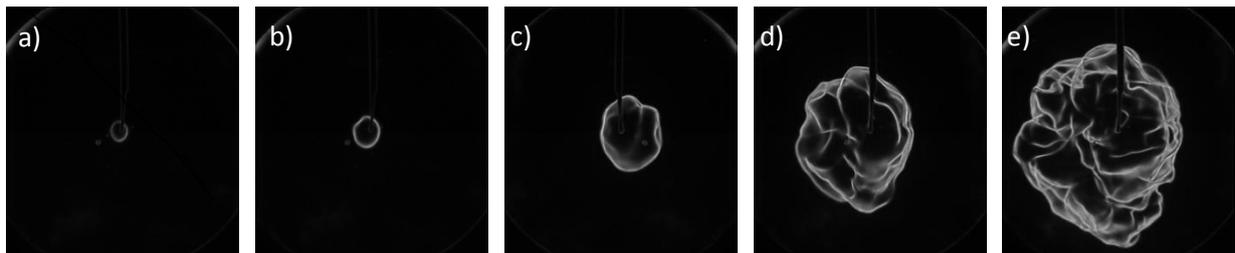
Figure 6.4 : Propagation d'une flamme turbulente en expansion (1 bar, 423 K,  $\phi = 1,0$ , 8000 tr/min), transition laminaire-turbulente en Schlieren. (a) 1,0 ms, (b) 2,0 ms, (c) 4,0 ms, (d) 6,0 ms et (e) 7,5 ms.
