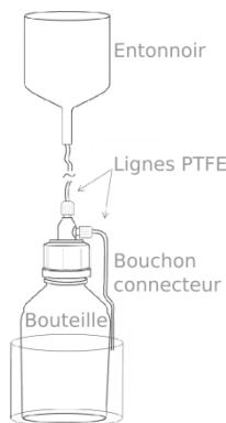
Figure 3-8: Schéma du système de collecte des précipitations.
