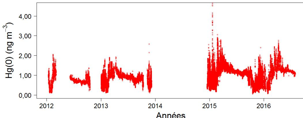
Figure 5-13: Concentrations moyennes en Hg(0) (pas de temps horaire, en  $\text{ng m}^{-3}$ ) enregistrées à DC entre janvier 2012 et fin juillet 2016. Les données de l’année 2013 sont celles à 210 cm. Une défaillance de l’instrument de mesures explique l’absence de données en 2014.
