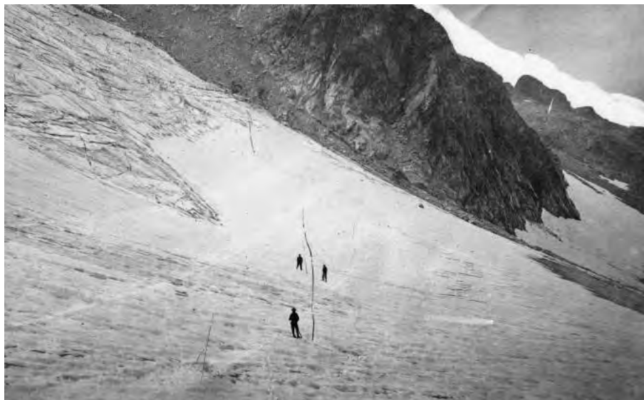
FIGURE 4.2 – Mesures du « champs de vitesses » du glacier de la Maladeta en 1876. Ces mesures ne seront hélas pas couronnées de succès, Eugène Trutat ne retrouvant pas les piquets installés d’une année sur l’autre.
