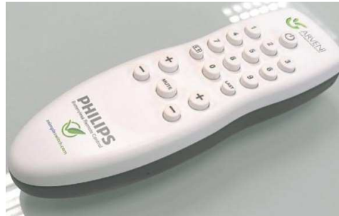
Figure 1-4 Télécommande piézoélectrique sans pile [6]
