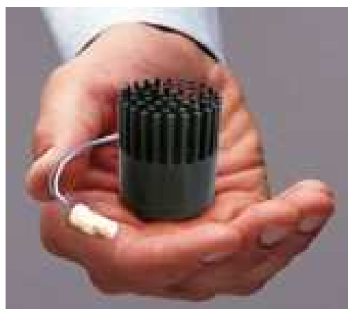
Figure I-1 Générateur thermoélectrique développé par la société PERPETUA [2]
