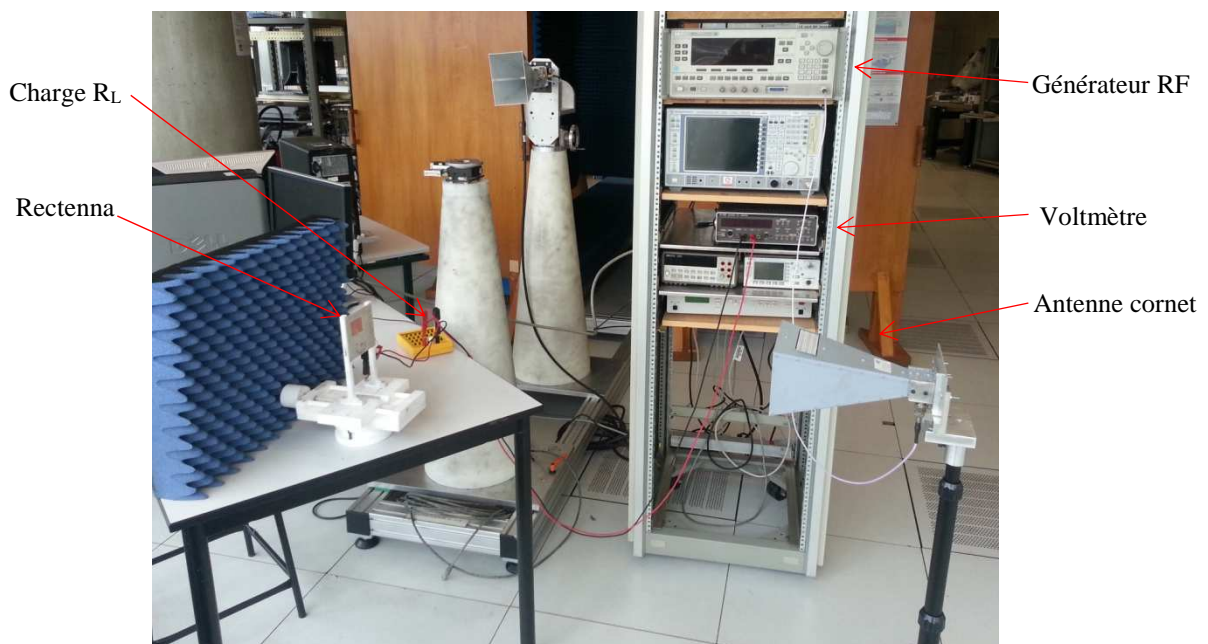
Figure 2- 44 Banc de mesure dédié
