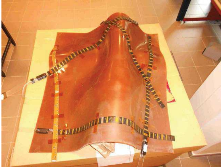
FIGURE 5.1 – Dispositif d'acquisition en réseau
