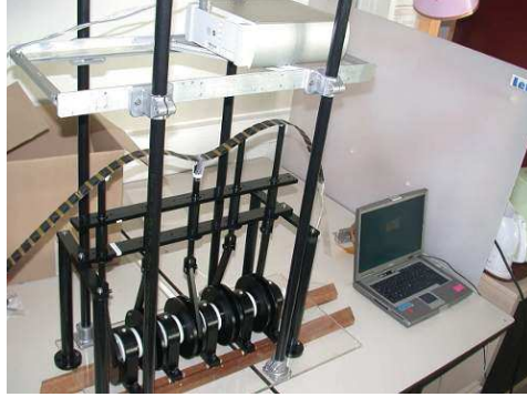
FIGURE 1.18 – Version 1D de la plateforme déjà développée : rampe munie de vérins.
