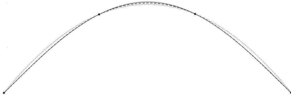
FIGURE 2.2 – Approximation d'un sinus (rouge) par une spline cubique (vert) et par une spline PH quintique sous contraintes de longueur (bleu). Les longueurs des différents segments sont ajustées de sorte à rendre la spline PH plane.
