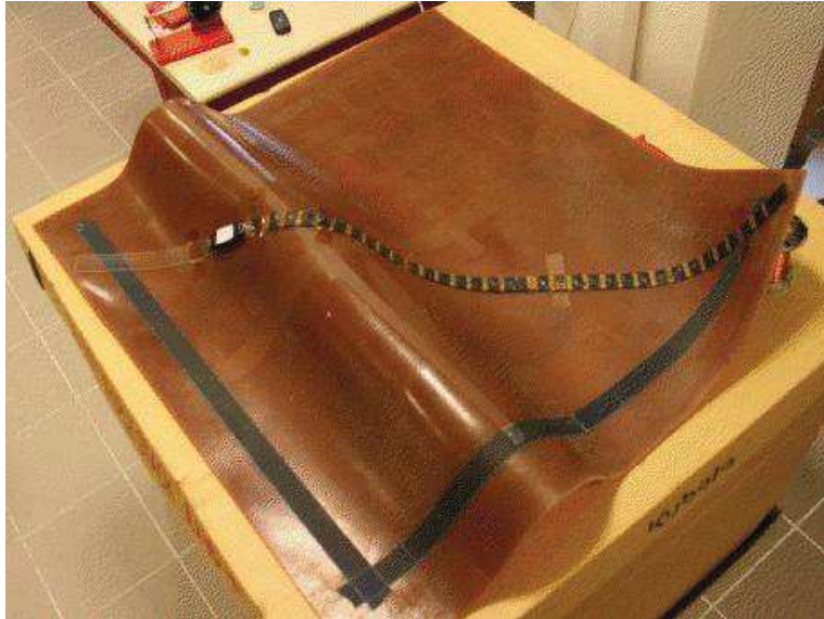
FIGURE 4.2 – Un ruban appliqué sur une surface développable
