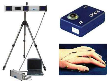
FIGURE 1.20 – Caméras, batterie et marqueurs de position du dispositif Coda Motion.
