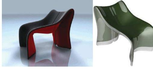
FIGURE 1.13 – Reconstruction d’une chaise à partir de quatre courbes géodésiques planaires.
