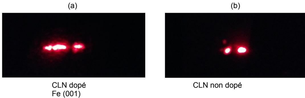
Fig. III.15 : Forme du faisceau rouge à la sortie du cristal. La figure (a) pour un CLN non dopé et (b) pour un CLN dopé fer (code 001 dans le Tableau III.1).
