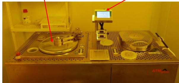
Fig. IV.19 : Machine d'enduction "tournette".
