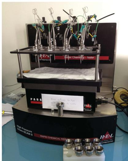
**Figure 45 : Autoclave pour les réactions en parallèle sous O<sub>2</sub>**
