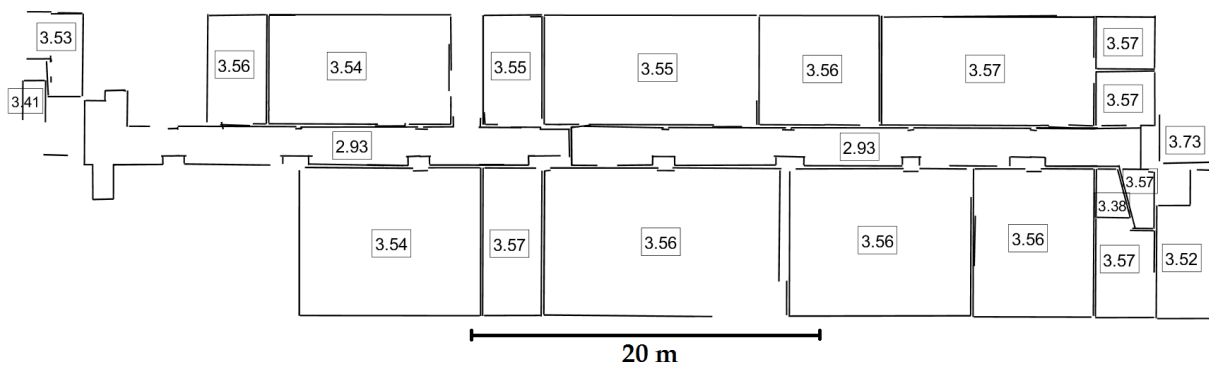
FIGURE 3.14 – Plan d'étage généré automatiquement avec les hauteurs sous-plafond identifiées - 1 er étage du bâtiment de l'INSA
