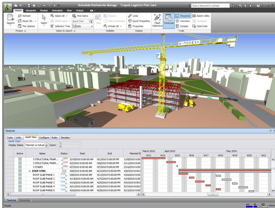
FIGURE 1.5 – Planification des projets de construction en 5D – Navisworks (Autodesk) (Source : www.autodesk.com – Navisworks, simulation et analyse de modèles)
