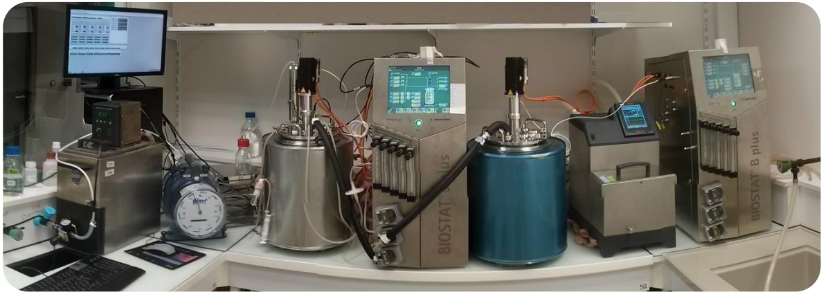
Figure 62 : Photo des bioréacteurs isolés réalisés par la société Eno Concept et le panneau de contrôle Sartorius BIOSTAT® B plus utilisés lors des expériences en fed-batch
