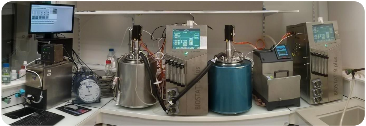
Figure 17 : Photo des bioréacteurs isolés réalisés par la société Ceno Concept et le panneau de contrôle de marque Sartorius BIostat® B utilisés lors des expériences en fed-batch
