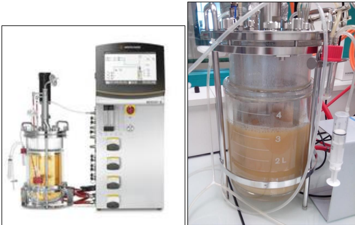
Figure 16 : Photo du bioréacteur de marque Sartorius BIOSTAT® B et son panneau de contrôle utilisés lors des expériences en batch
