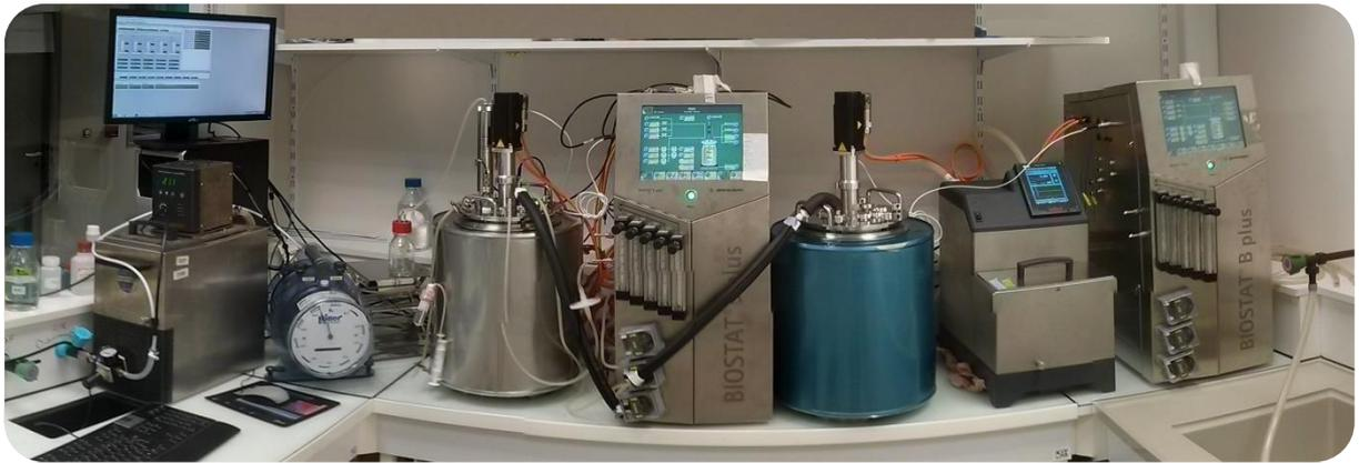
Figure 17 : Photo des bioréacteurs isolés réalisés par la société Ceno Concept et le panneau de contrôle de marque Sartorius BIostat® B utilisés lors des expériences en fed-batch
