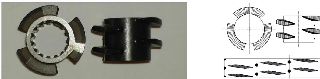
Figure 1-6 : Elément KE (Schéma : Brito-Bazan [3]).
