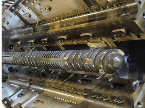
*Figure 1-2 : Co-malaxeur ouvert-vis avec sections de mélange et de transport-fourreau avec doigts.*
