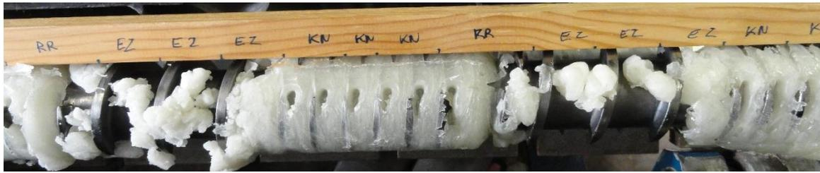
Figure 2-14 : Fourreau ouvert pour détermination du taux de remplissage.
