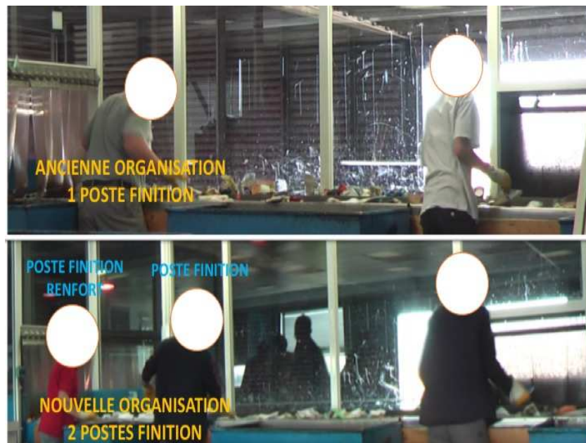
Figure 15 : photographies comparatives avant et après la création du poste de finition renfort sur le tapis de tri (CDT2)
