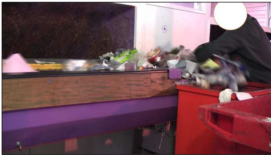
Figure 27 : opérateur au poste de finition du tapis corps creux, confronté à un dysfonctionnement technique et mettant massivement les déchets dans l'exutoire refus
