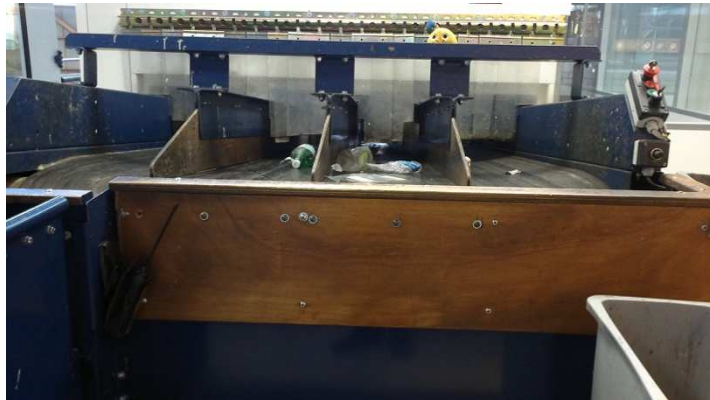
Figure 12 : poste de tri des corps creux (CDT4)
