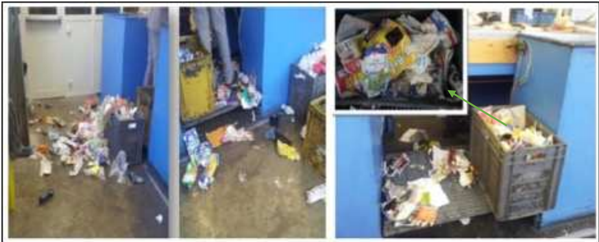
Figure 38 : exemples de conséquences de situations de débordement aux postes de finition sur le tapis JRM (CDT2)
