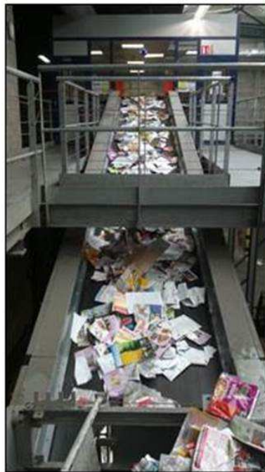
Figure 4 : tapis convoyeur des déchets vers les cabines de tri (CDTE)
