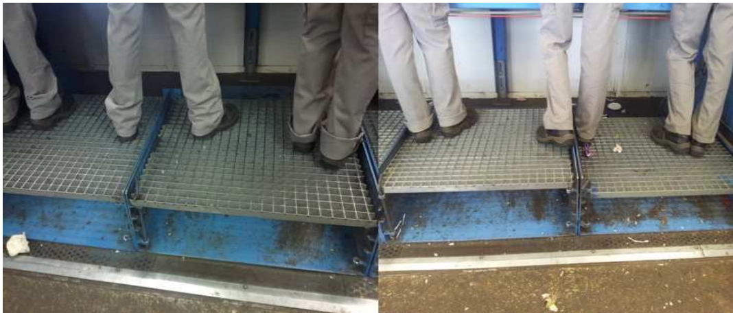
Figure 11 : positionnement sur les rehausseurs d'un opérateur en renfort sur un tapis de tri (CDT2)
