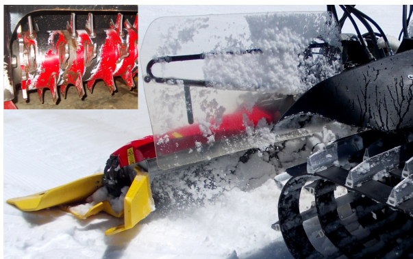
FIGURE 1.7 – La fraise est un outil monté à l'arrière de l'engin de damage constitué d'un arbre principal animé d'un mouvement de rotation surmonté de rangées de dents qui agissent comme un mixeur pour les couches de surface du manteau neigeux.
