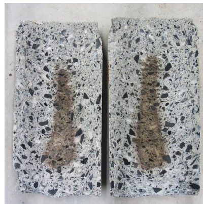
Figure 5-44 : Apparition de deux zones après pulvérisation et séchage du réactif
