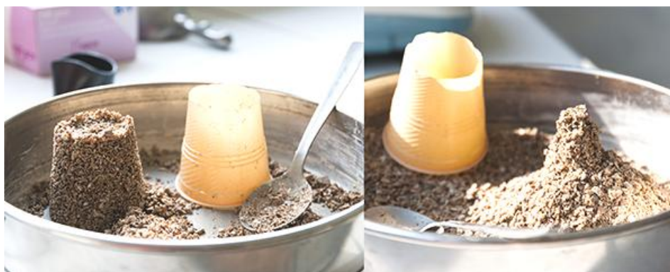
Figure 2-13 : Mesure du coefficient d'absorption des particules de d < 3,15 mm
