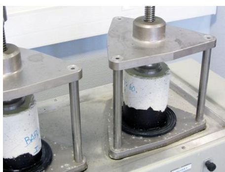
Figure 3-14 : Perméabilimètre à l'eau
