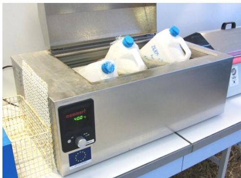
Figure 2-14 : Bain à 40°C pour la préparation des éluates
