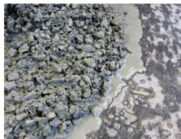
Figure 3-13 : Ressuage de laitance en périphérie de la galette
