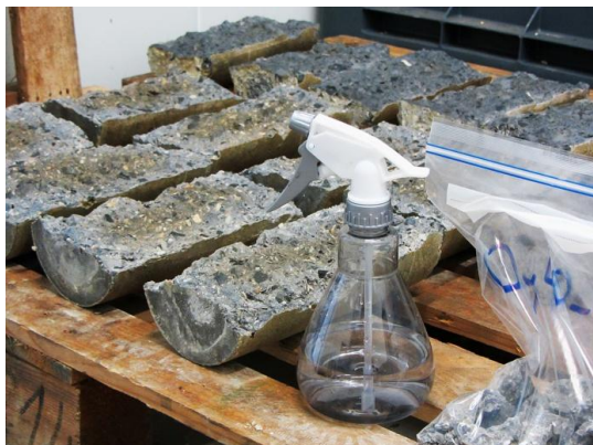
Figure 5-43 : Vaporisation du réactif pour la détermination du profil de pénétration des ions Cl -
