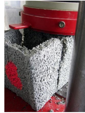
Figure 3-18 : Essai de compression sur bloc
