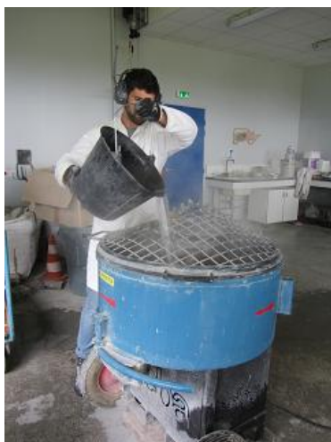
Figure 3-5 : Malaxeur à béton
