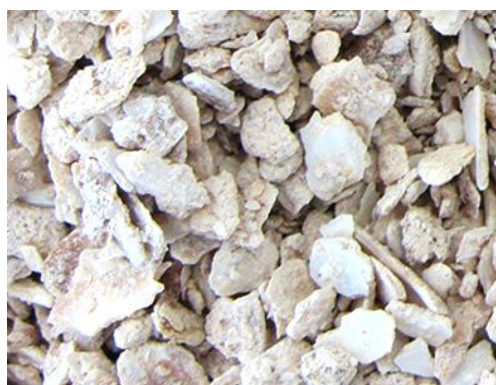
Figure 2-11 : Forme aplatie des coquilles concassées ( d > 4 mm)
