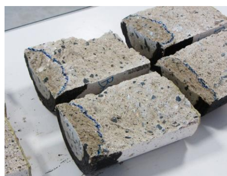
Figure 3-15 : Profil de pénétration d'eau
