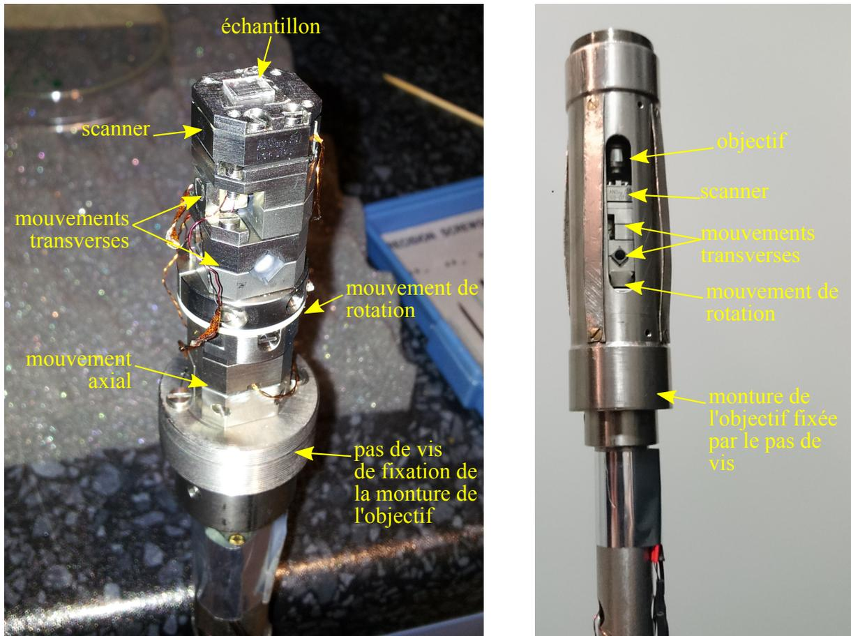
**Figure 2.3** – Photos de l'extrémité inférieure de la canne. À gauche, on distingue les cinq étages de nano-moteurs et l'échantillon. À droite, l'objectif est fixé à la canne grâce à sa monture cylindrique.
