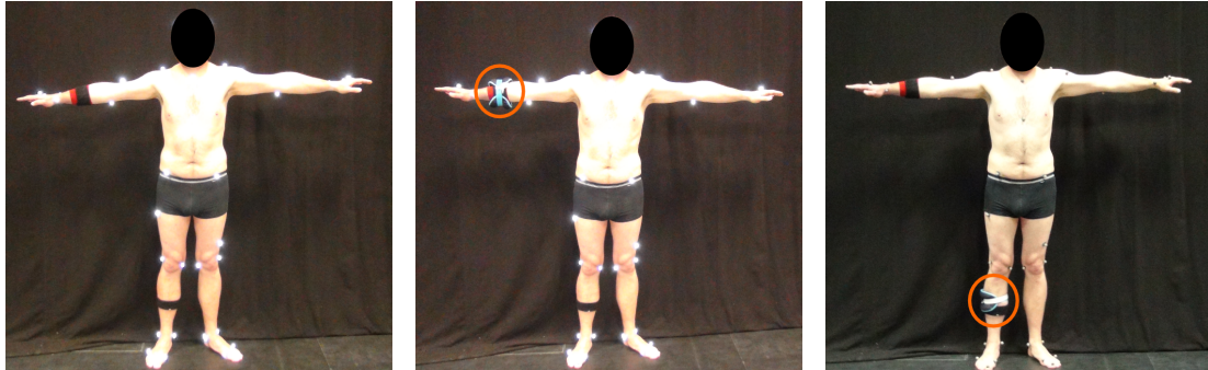
Figure 5.14 – Trois préparations d'un sujet avant la capture de mouvement : sans lest additionnel, avec un lest de 1 kg au niveau de l'avant-bras et avec un lest de 1 kg au niveau du tibia
