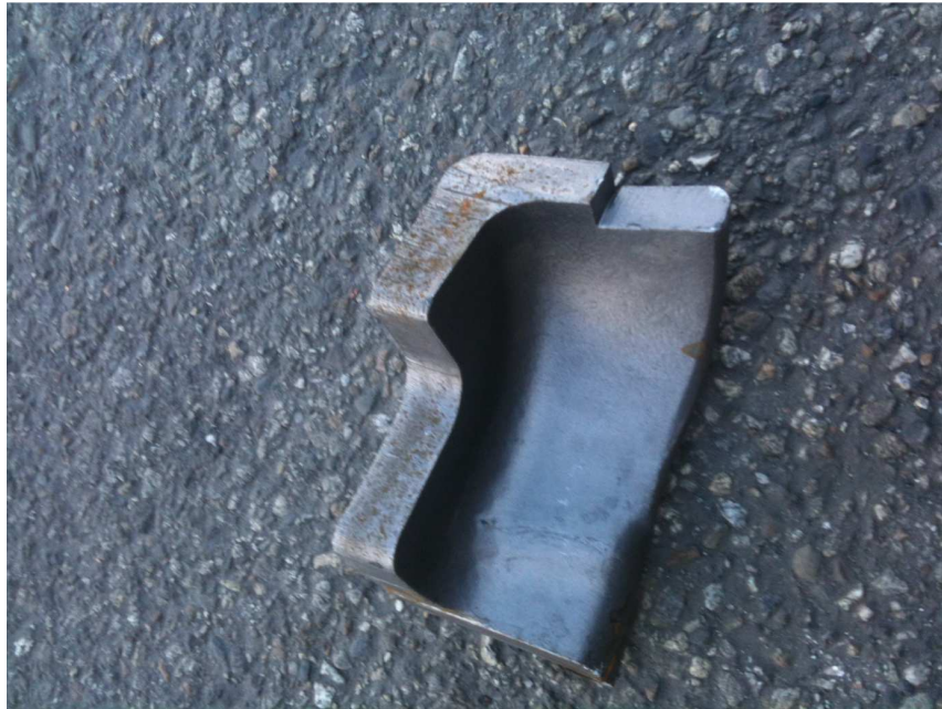
Figure 3 – Bloc de 15-5PH forgé durci à 1070 MPa
