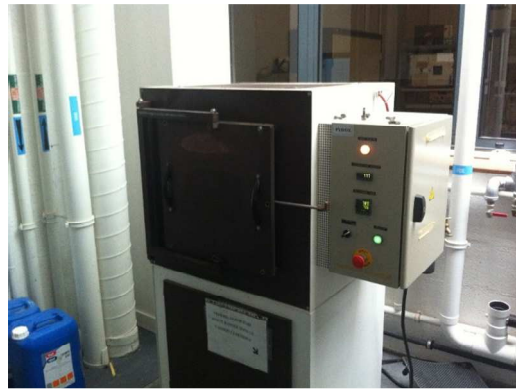
Figure B-26 – Four PYROX utilisé pour les vieillissements thermiques des blocs d'acier 15-5PH
