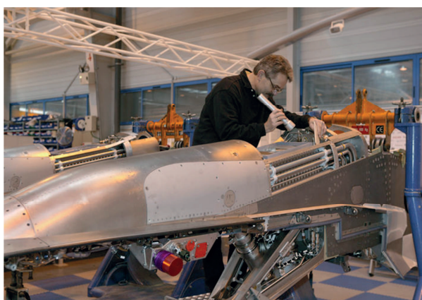
Figure A-1 – Mât-réacteur en maintenance
