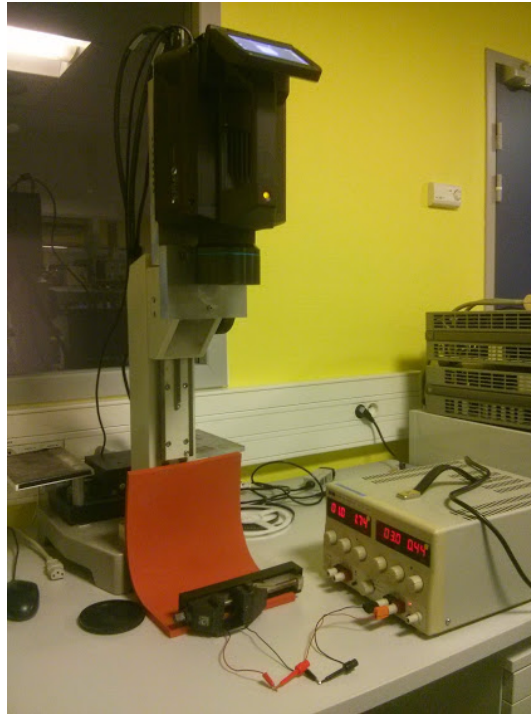
FIGURE 3.19 – Installation du capteur devant la caméra IR
