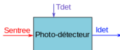
FIGURE 3.14 – Schéma bloc de la photo-diode
