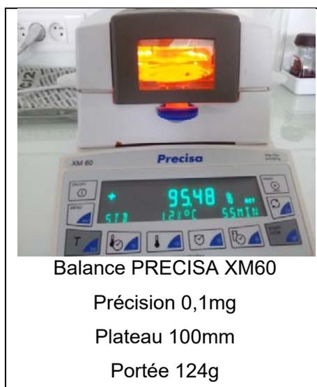
Figure 8 C3. Balance analytique à infra rouge.
