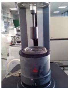
Figure 11 C3. Images du rhéomètre utilisé pour la mesure de la viscosité des fluides.
