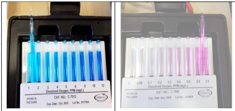
Figure 5 C3. Mesure de la teneur en oxygène avec le CHEMets colorimetric test kit.
