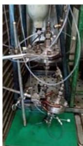
Figure 18 C3. Filtres installés sur les bouteilles de stockage de l'huile brute.
