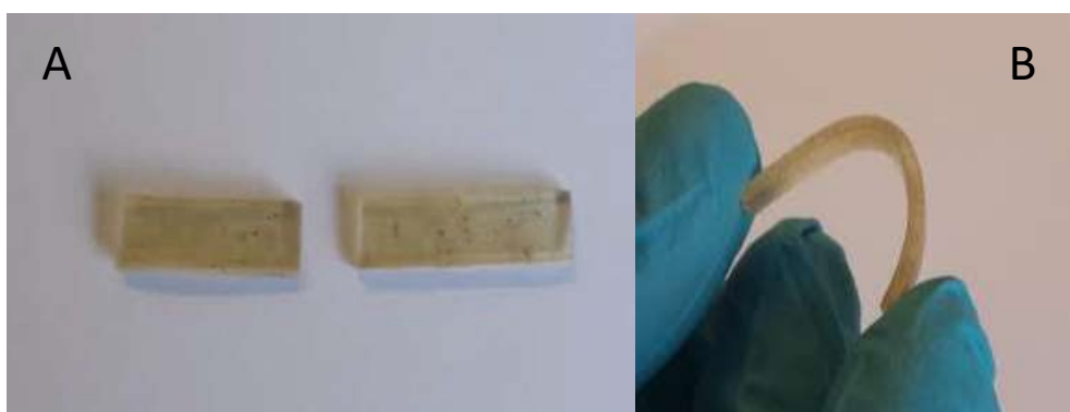
Figure 133 : Echantillon de Copo2 coupé en deux puis réparé.
