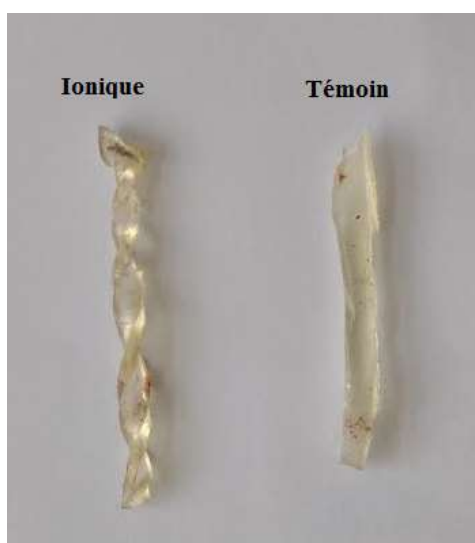
Figure 99 : Photos du résultat d'un test de remise en forme pour le matériau réticulé par des liaisons ioniques et le matériau témoin.
