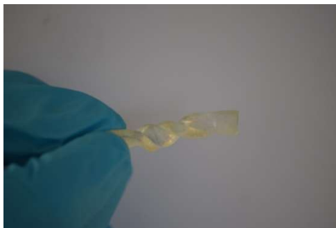
Figure 130 : Copo3 torsadé sous contrainte puis chauffé. La photo a été prise alors que l'échantillon n'est plus soumis à aucune contrainte.
