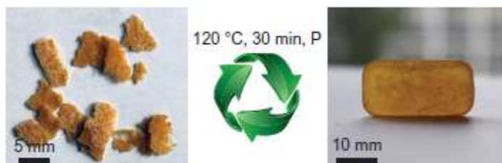
Figure 26 : Expérience de recyclage d'un matériau PU basé sur la réversibilité de la chimie click 61 .
