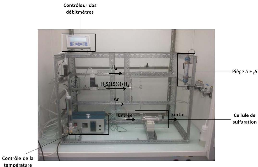
Figure 17 : Bâti de sulfuration.
