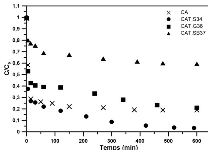
**Figure C-20.** Cinétiques de photocatalyse du phénol par les composites de différentes familles, concentration en phénol  $C_0$  : 100 mg.L<sup>-1</sup>, concentration en matériau  $C_{mat}$  : 1g/L, intensité UV  $I_{UV}$  : 34 W.m<sup>-2</sup>
