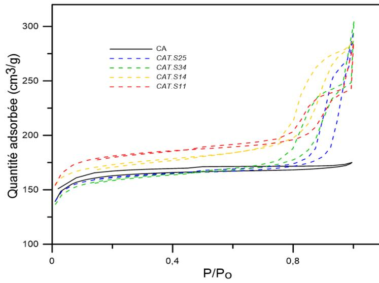
**Figure B-29.** Isothermes d'adsorption désorption N<sub>2</sub> des catalyseurs CAT.SX
