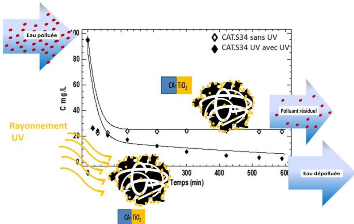
**Figure C-19.** Illustration schématique de l'élimination du phénol par un matériau CA-TiO<sub>2</sub> dans un cas irradié et dans un autre non irradié.
