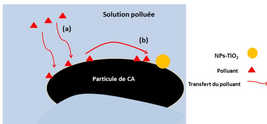
**Figure D-7.** Illustration schématique du transfert du polluant (a) de la solution vers le catalyseur CA- $\text{TiO}_2$  puis (b) du site d'adsorption vers les centres photoréactifs représentés par les NPs- $\text{TiO}_2$
