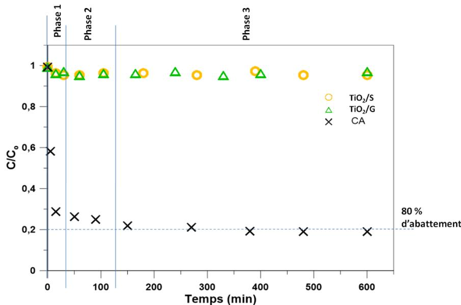
**Figure C-12.** Cinétiques d'adsorption du CA et des TiO<sub>2</sub> purs obtenus par voie sol gel (TiO<sub>2</sub>/G) et à partir de la suspension de nanoparticules (TiO<sub>2</sub>/S).  $C_0$  : 100mg/L,  $C_{mat}$  : 1g/L
