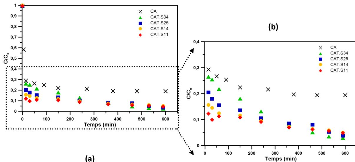
**Figure C-21.** Cinétiques de photocatalyse avec les matériaux *CAT.SX.*, concentration en phénol  $C_0$  :  $100 \text{ mg.L}^{-1}$ , concentration en matériau  $C_{\text{mat}}$  :  $1 \text{ g/L}$ , intensité UV  $I_{UV}$  :  $34 \text{ W.m}^{-2}$
