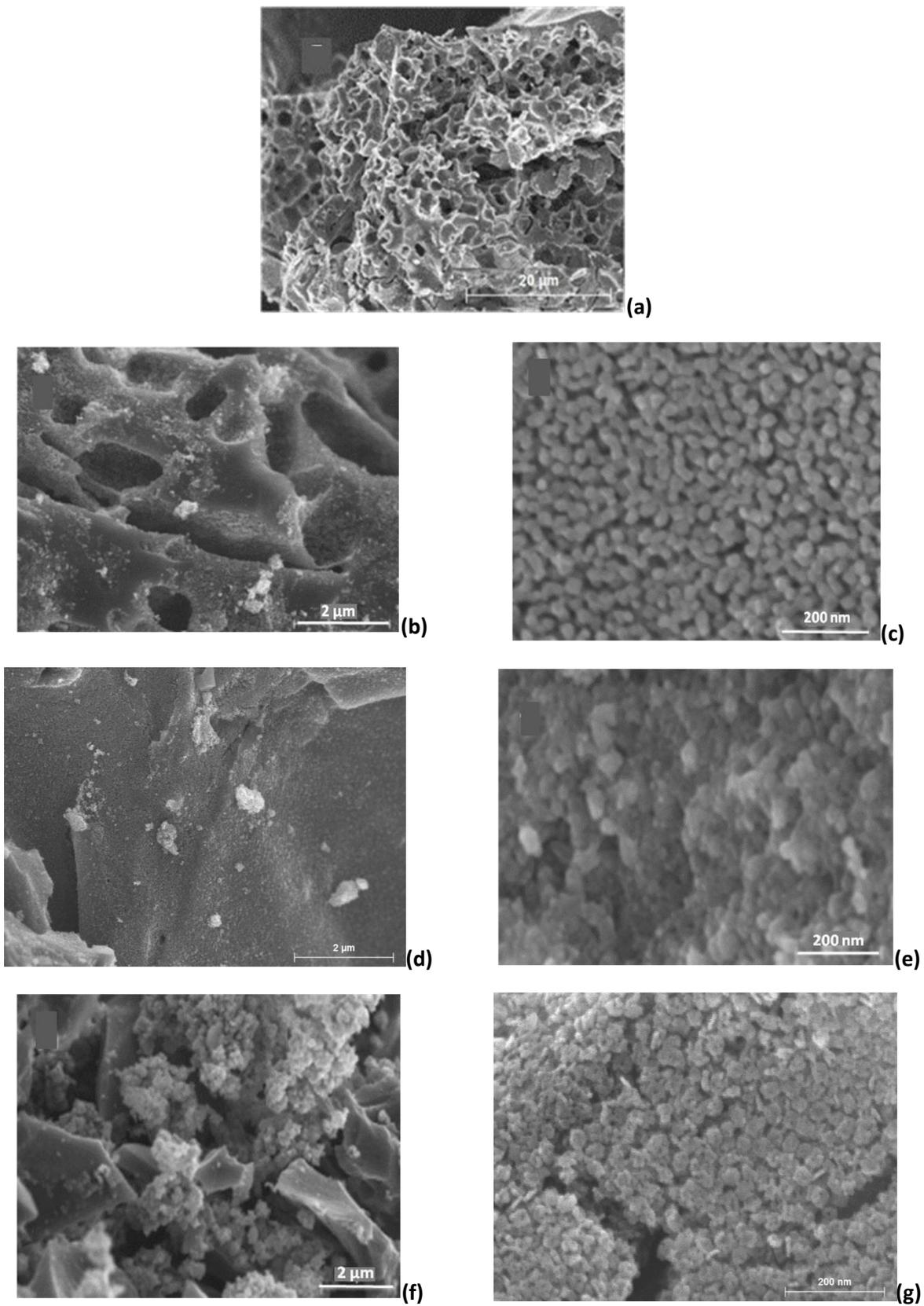
**Figure B-20.** Photographies MEB (a) du CA, et des matériaux CA-TiO<sub>2</sub> à différentes résolutions (b, c) *CAT.S25* (d, e) *CAT.G35* et (f, g) *CAT.SB37*.
