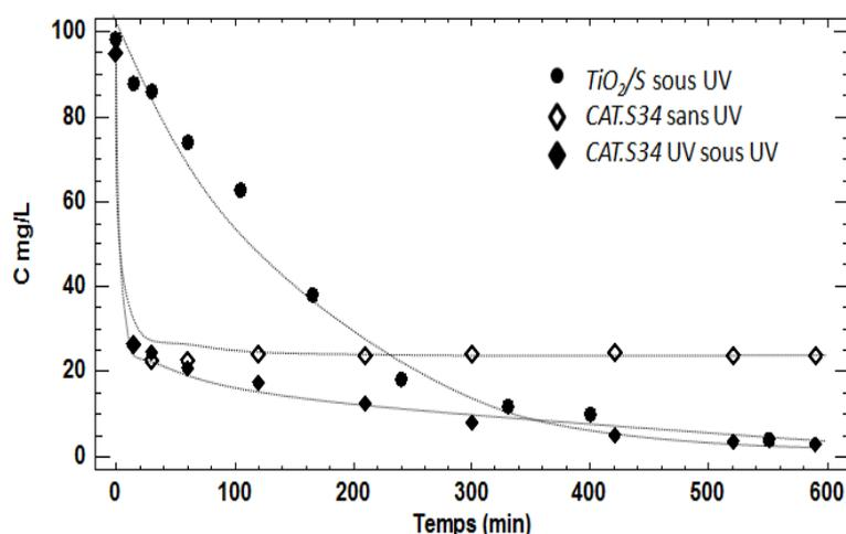
**Figure C-18.** Cinétiques de photocatalyse et d'adsorption du phénol par le  $TiO_2$  pur ( $TiO_2/S$ ) et le matériau composite *CAT.S34*, concentration en phénol  $C_0$  :  $100 \text{ mg.L}^{-1}$ , concentration en matériau  $C_{mat}$  :  $1 \text{ g/L}$ , intensité UV  $I_{UV}$  :  $34 \text{ W.m}^{-2}$
