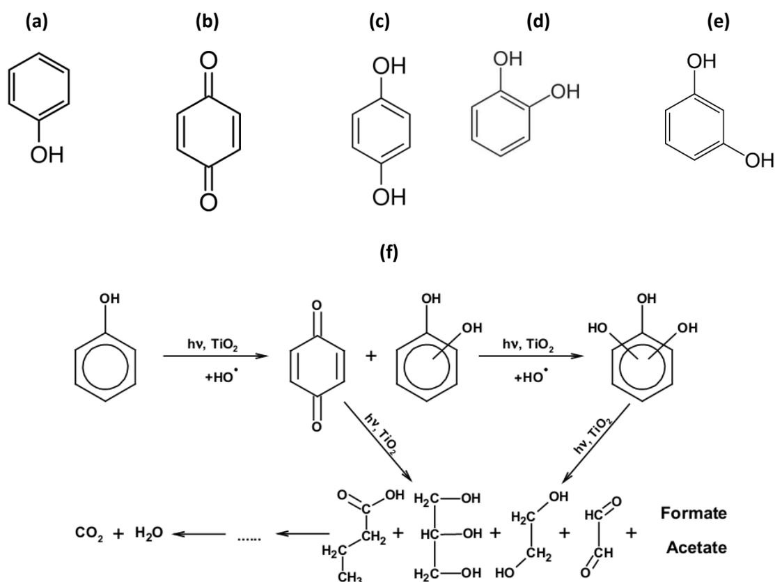
**Figure C-3.** Formules chimiques du (a) phénol, et des intermédiaires de dégradation (b) p-benzoquinone (c) hydroquinone (d) catéchol (e) résorcinol ; (f) Schéma simplifié des mécanismes de dégradation du phénol selon Sobczyński *et al.* [194]
