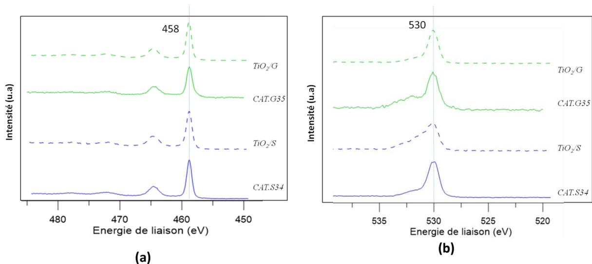
**Figure B-26.** Spectres XPS obtenus sur les matériaux CA-TiO<sub>2</sub> et les TiO<sub>2</sub> purs issus des différentes voies de synthèse (a) orbitale Ti2p et (b) orbitale O1s
