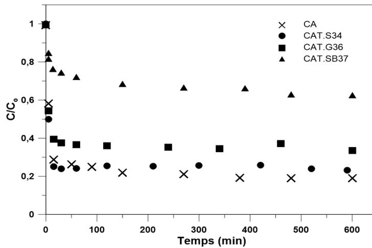
**Figure C-13.** Cinétiques d'adsorption des catalyseurs à teneurs en TiO<sub>2</sub> comparables C<sub>0</sub> : 100 mg.L<sup>-1</sup>, C<sub>mat</sub> : 1 g.L<sup>-1</sup>
