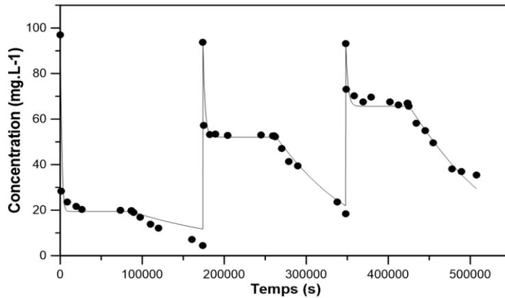
**Figure D-12.**Données expérimentales (●)et profil simulée(courbe continue) de la variation de la concentration en phénol sur plusieurs cycles d'utilisation du catalyseur *CAT.S25* soumis à un éclairage UV alterné
