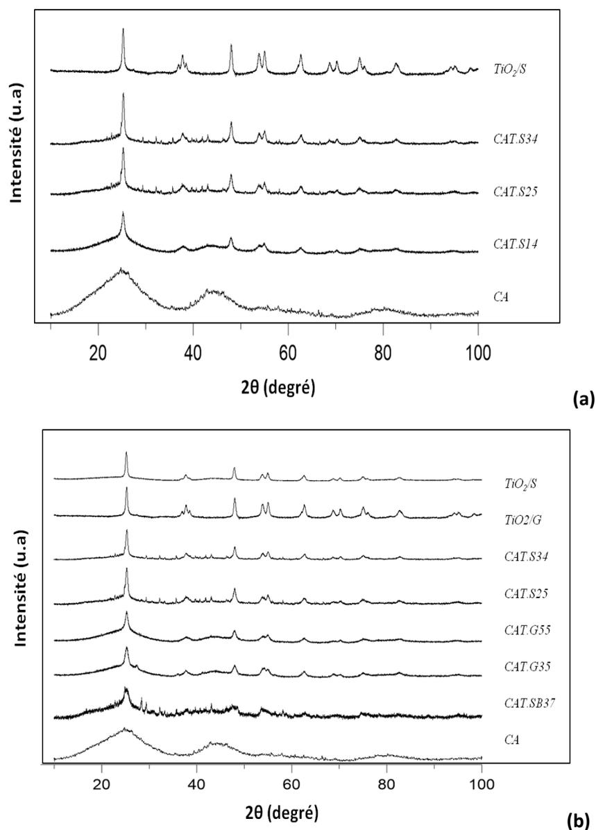
**Figure B-24.** Diffractogrammes X des matériaux (a) *CAT.SX* et (b) issus de différentes familles, comparés aux diffractogrammes des TiO<sub>2</sub> purs et du CA non imprégné
