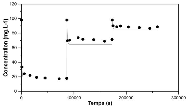
**Figure D-13.**Données expérimentales (●) et profil simulé(courbe continue) de la variation de la concentration en phénol sur plusieurs cycles d'utilisation du catalyseur *CAT.S25* en absence de lumière UV
