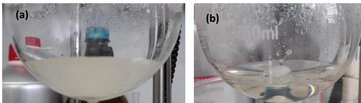
**Figure B-5.** Photographie d'un sol de TiO<sub>2</sub> (a) avant et (b) après 3h de repos
