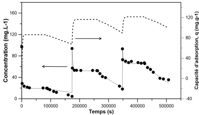
**Figure D-14.** Données expérimentales (●) et courbes simulées de la variation de la concentration en phénol (courbes continues) et de la capacité d'adsorption (courbes pointillées) du catalyseur CAT.S25 soumis à plusieurs cycles d'utilisation sous éclairage UV alterné
