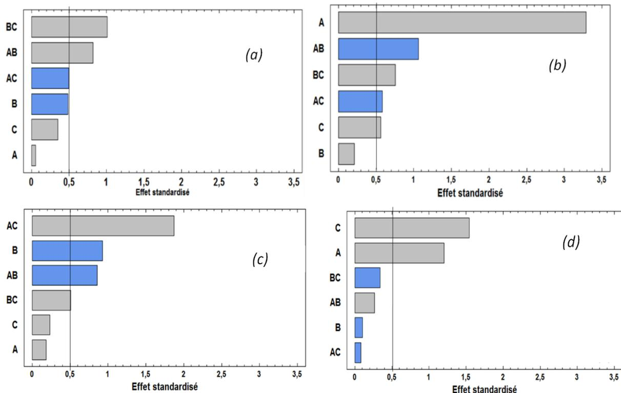
**Figure B-13.** Influences des facteurs expérimentaux quantitatifs et leurs interactions sur les indices  $I_{BM}$  des matériaux (a) *CA.ck*, (b) *CA.ch* (c) *CA.bk* et (d) *CA.bh*. : (A) Température de pyrolyse (B) Vitesse de chauffe (C) Concentration agent activant, ■ Effet négatif, ■ Effet positif
