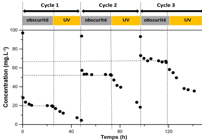
**Figure D-6.** Cinétiques de disparition du phénol sur plusieurs cycles d'utilisation du catalyseur CAT.S25 suivant des cycles alternés avec et sans lumière UV. concentration en catalyseur  $C_{cat}$ :  $1\text{g.L}^{-1}$ , concentration en phénol  $C_o$ :  $100\text{mg.L}^{-1}$ , Intensité UV  $I_{UV}$ :  $34\text{W.m}^{-2}$
