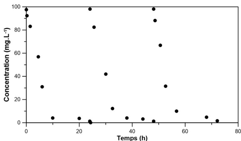
**Figure D-5.** Cinétiques de disparition du phénol sur plusieurs cycles d'utilisation du  $\text{TiO}_2$  pur. concentration en catalyseur  $C_{\text{cat}}$ :  $1\text{g.L}^{-1}$ , concentration en phénol  $C_0$ :  $100\text{mg.L}^{-1}$ , Intensité UV  $I_{\text{UV}}$ :  $34\text{W.m}^{-2}$
