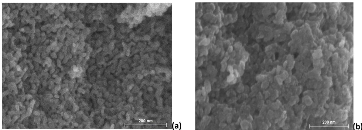
**Figure B-21.** Photographies MEB des matériaux (a) *TiO<sub>2</sub>/S* et (b) *TiO<sub>2</sub>/G*
