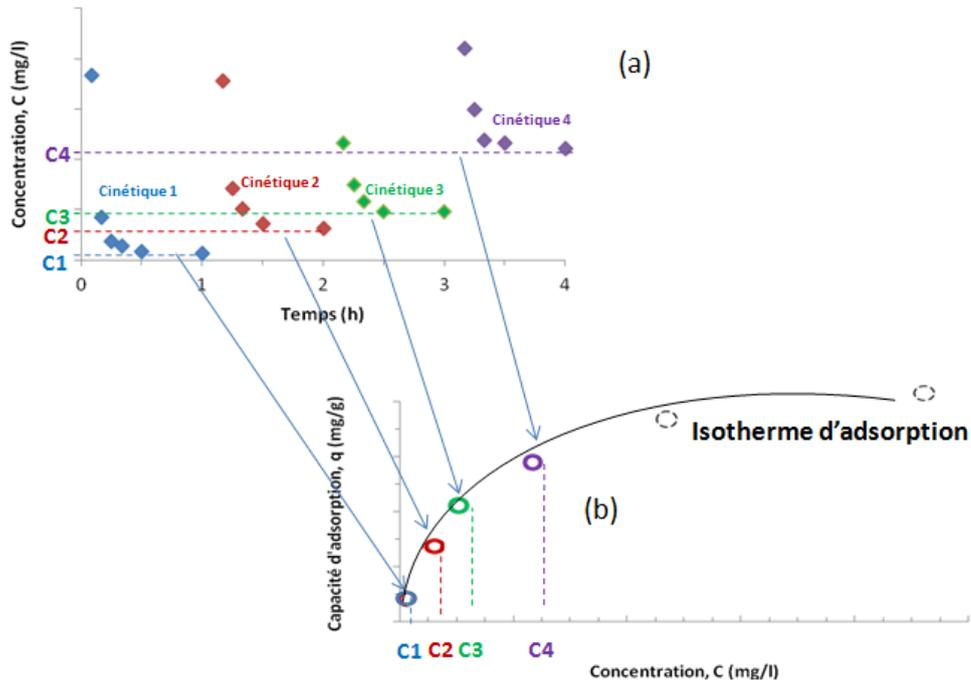
**Figure C-4.** Principe de détermination des courbes d'isothermes. (a) Utilisation des conditions d'équilibre d'adsorption indiquées par une concentration en phénol constante en fonction du temps pour (b) l'obtention des points d'isothermes.
