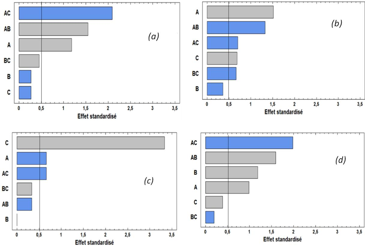
**Figure B-12.** Influences des facteurs expérimentaux quantitatifs et leurs interactions sur l'indice  $I_2$  des matériaux (a) CA.ck, (b) CA.ch(c) CA.bk et (d) CA.bh, Facteurs d'influence : (A) Température de pyrolyse (B) Vitesse de chauffe (C) Concentration agent activant.
