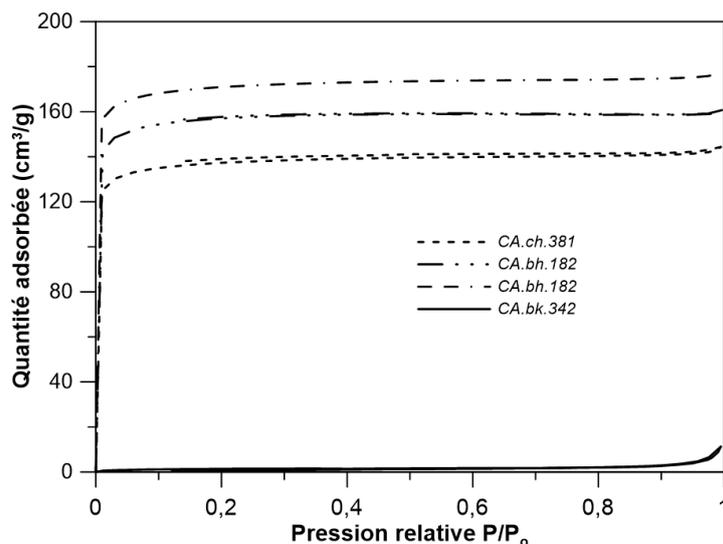
**Figure B-16.** Isotherme d'adsorption N<sub>2</sub> des CA présélectionnés pour l'imprégnation du TiO<sub>2</sub>.
