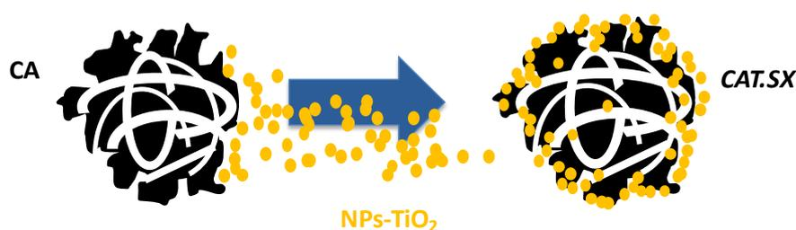
**Figure D-16.** Illustration schématique de la fixation du TiO<sub>2</sub> sur la porosité externe du charbon actif pendant la synthèse des catalyseurs *CAT.SX*,
