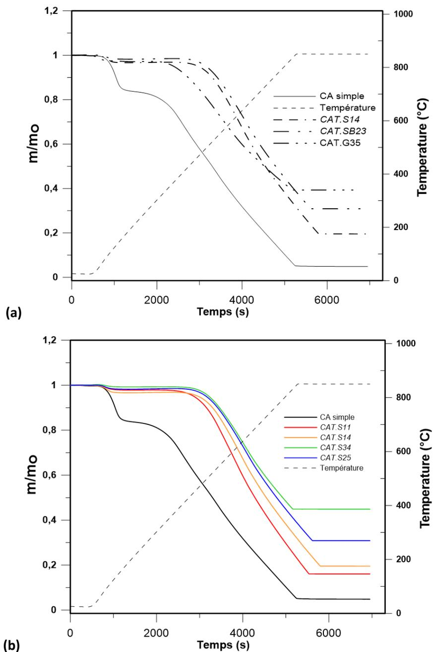
**Figure B-18.** Suivi de la variation de masses des matériaux CA-TiO<sub>2</sub>(a) matériaux de différentes familles (b) matériaux CAT.SX (vitesse de chauffe 5°C/min, débit air: 21 mL/min)
