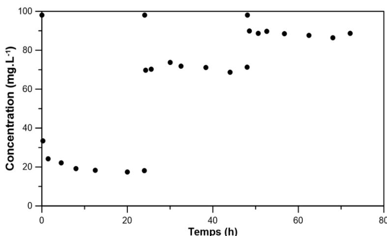
**Figure D-2.** Profil de disparition du phénol sur plusieurs cycles d'utilisation du CA non imprégné sous irradiation UV, teneur en catalyseur  $C_{cat}$ :  $1g.L^{-1}$ , concentration en polluant  $C_o$ :  $100 mg.L^{-1}$ , Intensité UV  $I_{UV}$ :  $34 W.m^{-2}$
