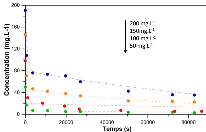
**Figure D-9.** Données expérimentales (●) et profils simulés (courbes pointillées) de la variation de la concentration en phénol sur le catalyseur *CAT.S25* soumis à différentes concentrations en phénol :
