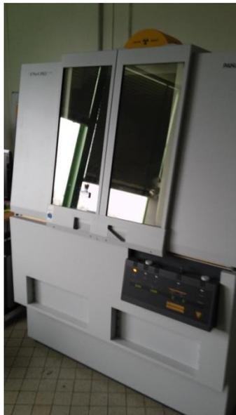
Appareil de Diffraction aux rayons X modèle *Panalytical X'Pert Pro MPD* (PROMES Odeillo)
