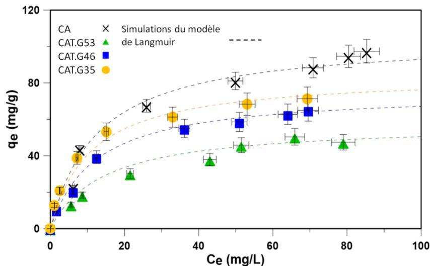
**Figure C-8.** Données expérimentales et simulées des isothermes d'adsorption du phénol par le CA et les catalyseurs *CAT.GX* élaborés à 35, 46 et 53% de  $\text{TiO}_2$
