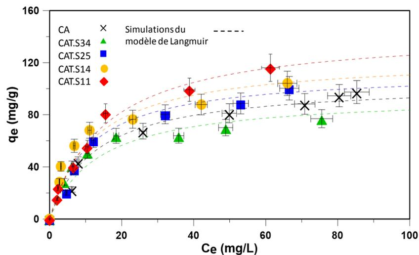
**Figure C.7.** Données expérimentales et simulées des isothermes d'adsorption du phénol par le CA et les matériaux *CAT.SX* élaborés à 34, 25, 14 et 11% de  $TiO_2$ . Pour les matériaux composites, les données simulées sont dérivées de l'isotherme réduite
