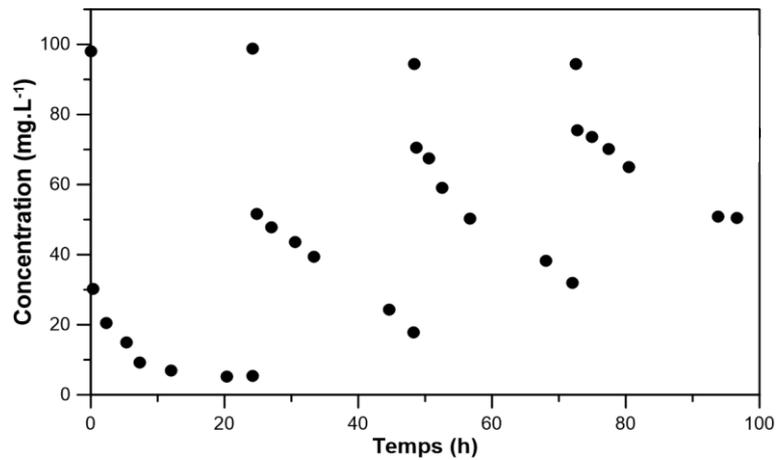
**Figure D-3.** profil de disparition du phénol sur plusieurs cycles d'utilisation du catalyseur *CAT.S25* sous éclairage UV. Teneur en catalyseur :  $1\text{g.L}^{-1}$ ,  $C_0$  :  $100\text{mg.L}^{-1}$ ,  $I_{UV}$  :  $34\text{W.m}^{-2}$
