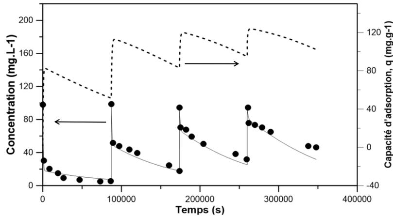
**Figure D-11.** Données expérimentales (●) et profils simulés de la variation de la concentration en phénol (courbe continue) et de la capacité d'adsorption (courbe pointillée) du catalyseur CAT.S25 soumis à plusieurs cycles d'utilisation sous éclairage UV continu
