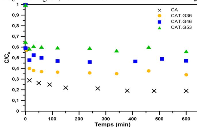
**Figure C-15.** Cinétiques d'adsorption du phénol par les matériaux composites *CAT.GX*, concentration en phénol  $C_0 : 100 \text{ mg.L}^{-1}$ , concentration en matériau adsorbant  $C_{\text{ads}} : 1 \text{ g/L}$
