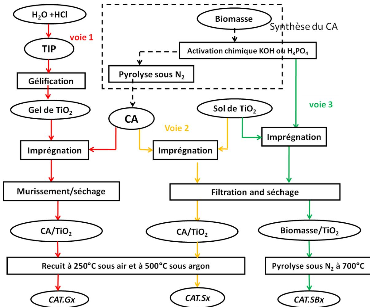
**Figure B-6.** Diagramme de procédures expérimentales d'élaboration des différentes familles de matériaux CA-TiO<sub>2</sub>
