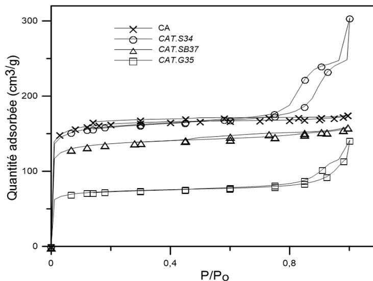
**Figure B-27.** Isothermes d'adsorption/désorption N<sub>2</sub> des matériaux CA-TiO<sub>2</sub> issus des différentes voies de synthèse
