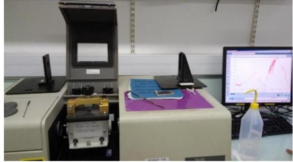
Spectrophotomètre infrarouge marque *Nicolet 710* (IEM)
