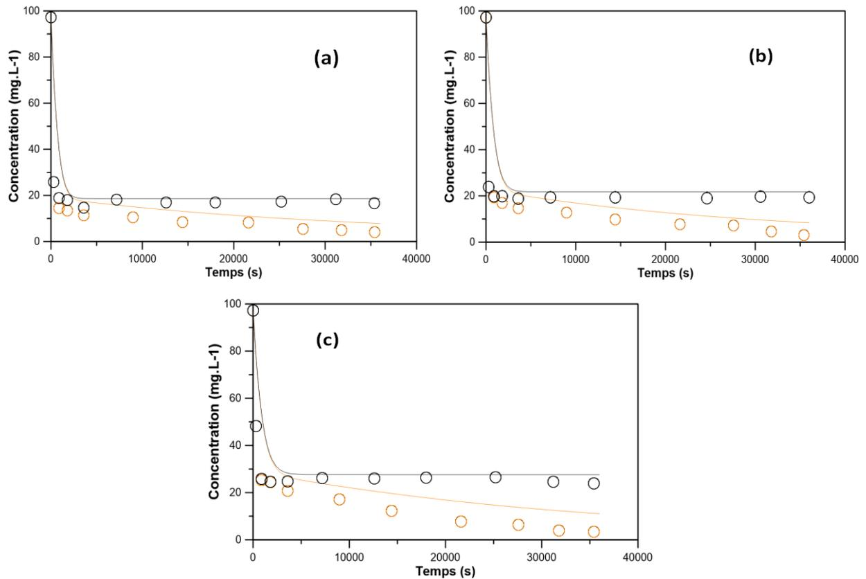
**Figure D-8.** Données expérimentales (●●) et courbes simulées (— —) des cinétiques d'adsorption (en noir) et photodégradation (en jaune) du phénol par les catalyseurs *CAT.SX* de teneurs en TiO<sub>2</sub> (a) 14 %, (b) 25 % et (c) 34 %.
