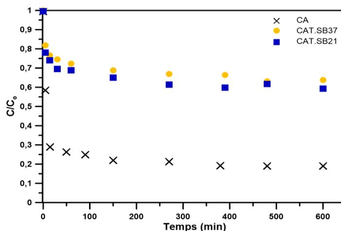
**Figure C-16.** Cinétiques d'adsorption du phénol par les matériaux composites *CAT.SBX*, concentration en phénol  $C_0 : 100 \text{ mg.L}^{-1}$ , concentration en matériau adsorbant  $C_{\text{ads}} : 1 \text{ g/L}$
