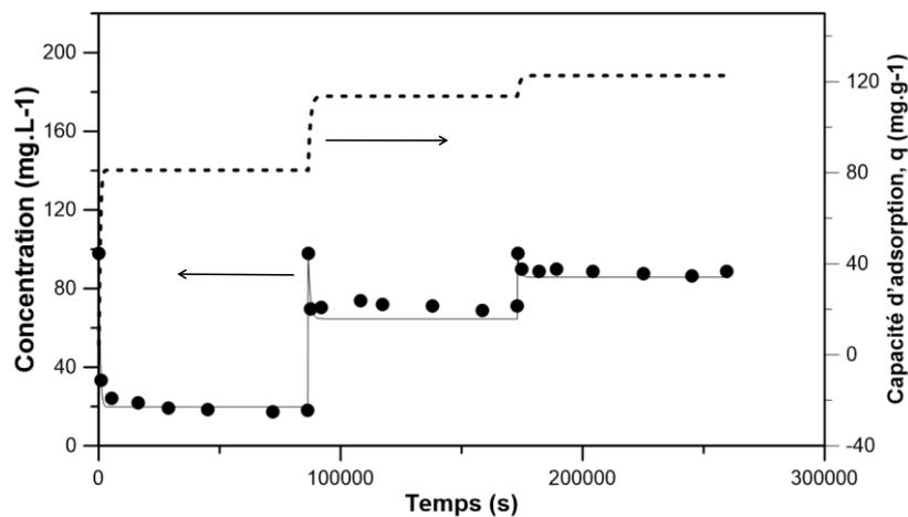
**Figure D-15.** Données expérimentales (●) et courbes simulées de la variation de la concentration en phénol (courbes continues) et de la capacité d'adsorption (courbes pointillées) du catalyseur CAT.S25 soumis à plusieurs cycles d'utilisation en absence de lumière UV
