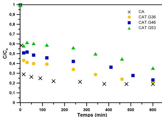
**Figure C-22.** Cinétique de photocatalyse des matériaux *CAT.GX*, concentration en phénol  $C_0$  : 100  $\text{mg.L}^{-1}$ , concentration en matériau  $C_{\text{mat}}$  : 1  $\text{g/L}$ , intensité UV  $I_{\text{UV}}$  : 34  $\text{W.m}^{-2}$
