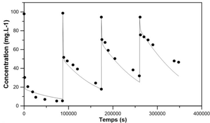
**Figure D-10.** Données expérimentales (●) et profil simulé (courbe continue) de la variation de la concentration en phénol sur plusieurs cycles d'utilisation du catalyseur *CAT.S25* soumis à un éclairage UV continu
