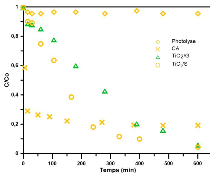
**Figure C-17.** Cinétiques de photolyse et de photocatalyse avec le CA et les matériaux  $\text{TiO}_2$  purs issus du sol commercial ( $\text{TiO}_2/\text{S}$ ) et du sol gel ( $\text{TiO}_2/\text{G}$ ), concentration en phénol  $C_0$  : 100  $\text{mg.L}^{-1}$ , concentration en matériau  $C_{\text{mat}}$  : 1  $\text{g/L}$ , intensité UV  $I_{\text{UV}}$  : 34  $\text{W.m}^{-2}$
