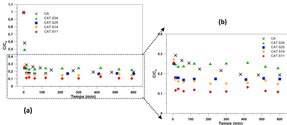
**Figure C-14.** Cinétiques d'adsorption du phénol par les matériaux composites *CAT.SX*, concentration
