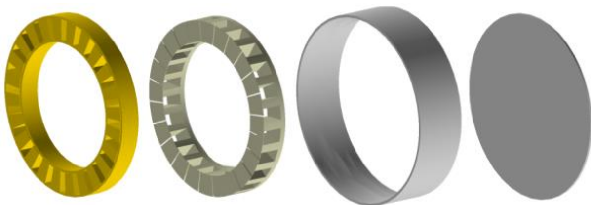
Fig. IV.24. Vue éclatée de la machine à aimants permanents à flux axial modélisée par éléments finis.
