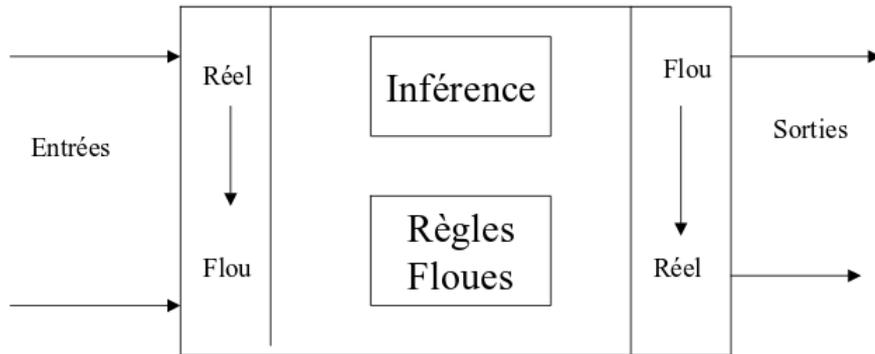
FIGURE 4.3 – Architecture d'un système de logique floue
