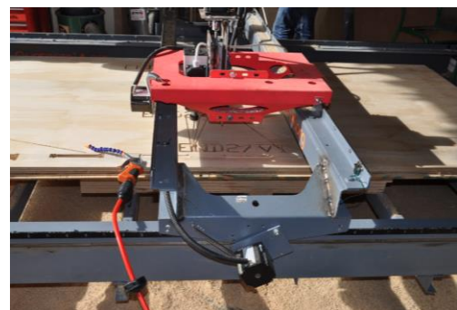
Fig. 30 Fraiseuse CNC open source
