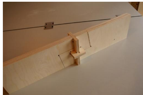
Figs 6, 7 Assemblage par S-Joint des membrures des cadres en contreplaqué
