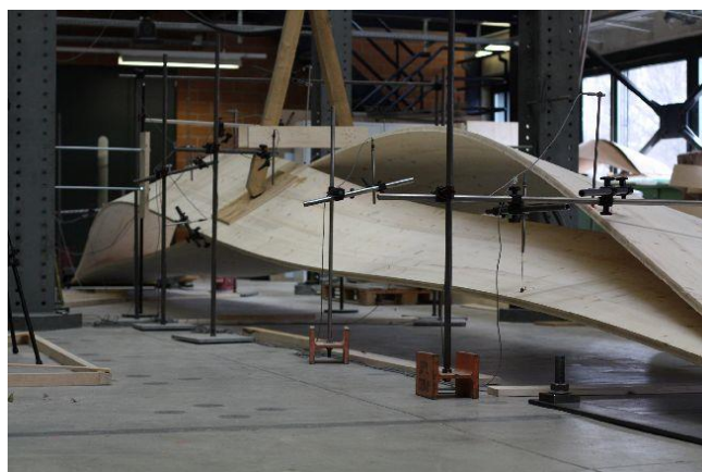
Fig. 17 Essais mécanique sur une structure tressée
