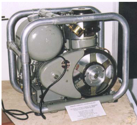
(a) Le générateur portable à moteur Stirling de PHILIPS : configuration beta, puissance de 200 W, pression moyenne de 1,35 MPa [82]
