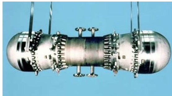
(b) Générateur expérimental de la NASA : moteur Stirling de configuration beta à pistons, puissance de 2x12,5 kW
