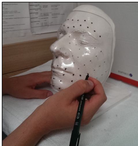
Figure 100 : Report des points sur le masque en vue du perçage.
