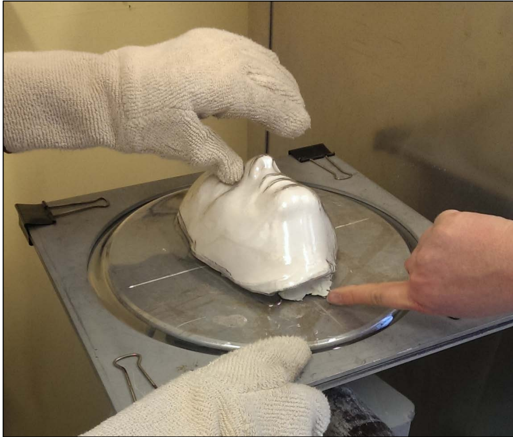
Figure 99 : Thermoformage du masque à l'aide d'une plaque aspirante.
