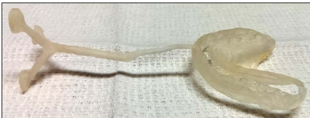
Figure 38 : Le référentiel maxillaire permet de supporter 3 marqueurs réfléchissants. Il retransmet les mouvements du crâne par l'intermédiaire du maxillaire.
