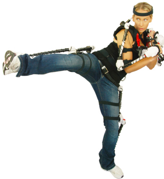
Figure 18 : Gypsy-7 de Animazoo Ltd , exosquelette avec gyroscopes ( www.animazoo.fr ).
