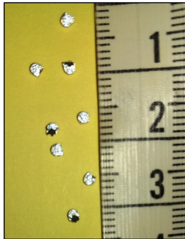
Figure 32 : Marqueurs réfléchissants de 1,5mm utilisés dans ce protocole.
