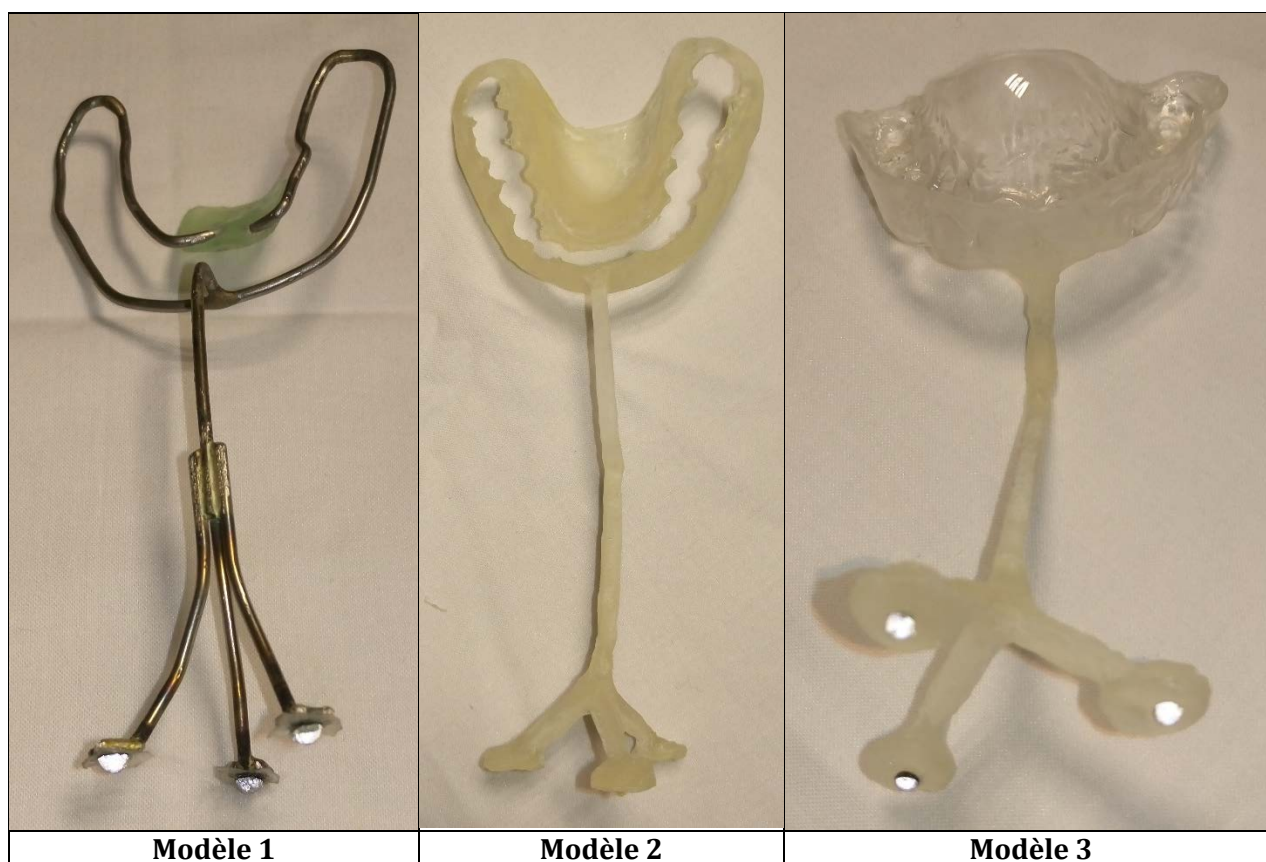
Figure 101 : Les trois modèles de gouttière par ordre chronologique. Le modèle 4 se différencie du 3 par l'inclusion d'un fil de métal dans la tige.
