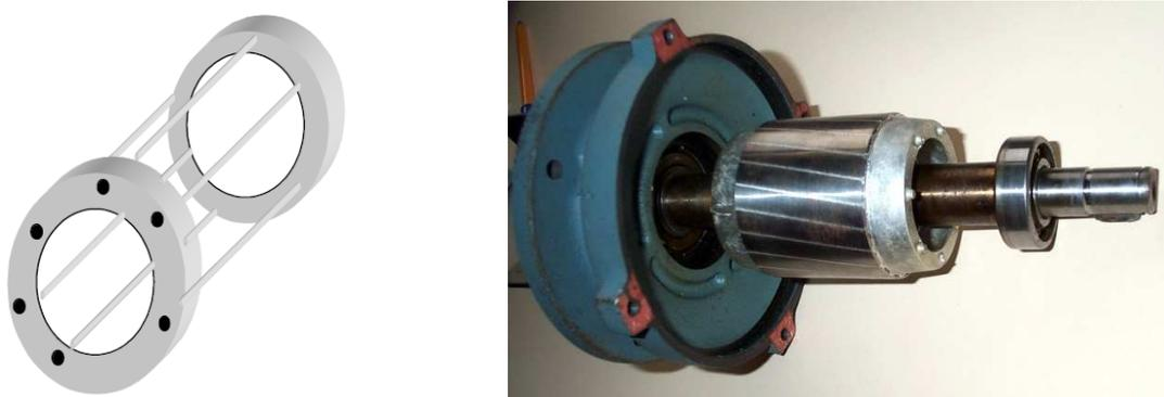
**Figure 2 Rotor à cage d'écureuil de machine asynchrone**
