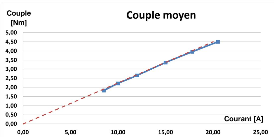
**Figure 219 Couple en fonction du courant efficace à 500 tours par minute**
