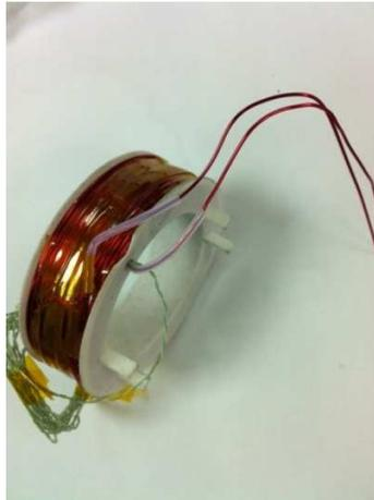
**Figure 246 Bobinage d'excitation**
