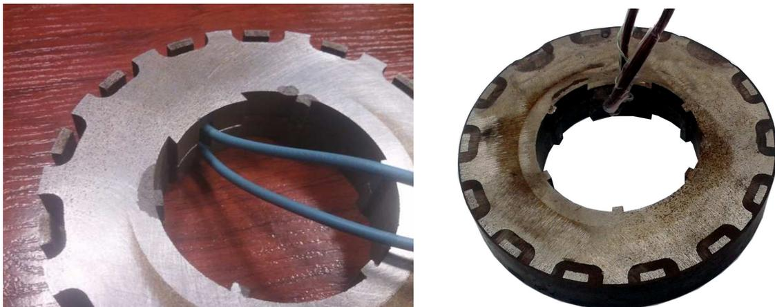
**Figure 213** *Phase stator avant (à gauche) et après résinage (à droite)*
