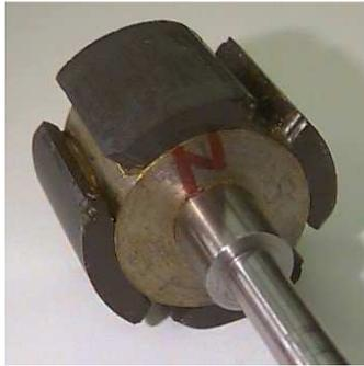
**Figure 7** Rotor de machine synchrone à aimants permanents en surface
