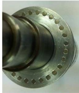
**Figure 174** *Aimants pastilles assurant la mesure de position montés sur le rotor*
