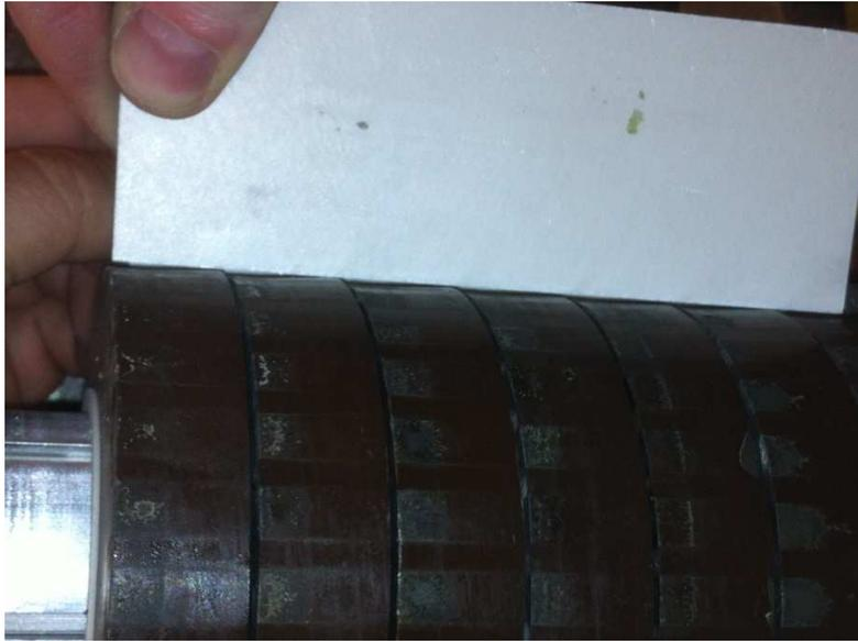
**Figure 221** *Irrégularités du stator assemblé*
