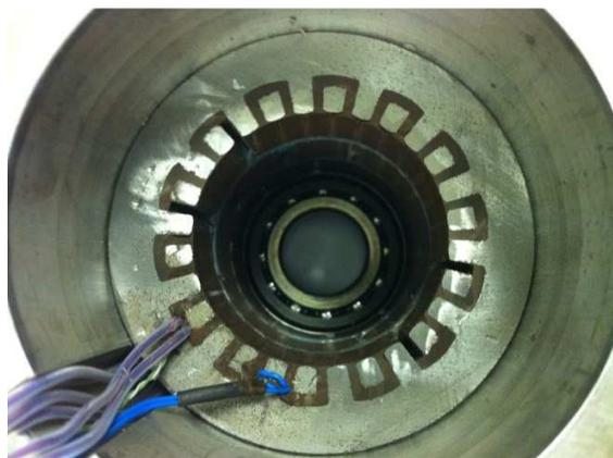
**Figure 172 Intérieur du stator assemblé**
