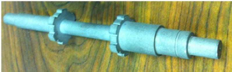
**Figure 244** Arbre cannelé
