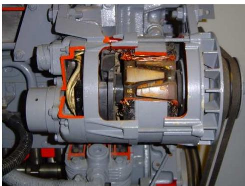
**Figure 32** *Alternateur à griffes d'automobile*
