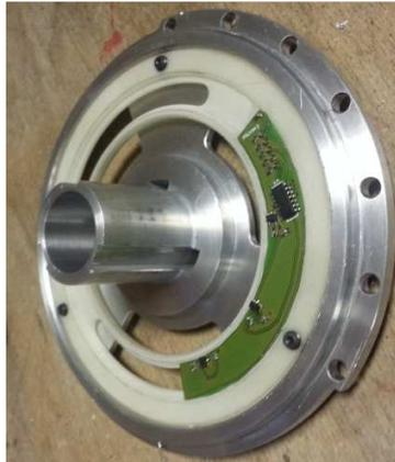
**Figure 215** Circuit imprimé supportant les capteurs à effet Hall (mesure de position)
