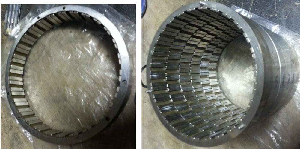
**Figure 214** Rotor, une phase (à gauche) et six phases assemblées(à droite)
