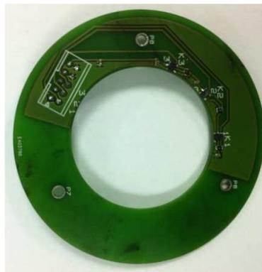
**Figure 175** *Circuit imprimé supportant les capteurs à effet Hall pour la mesure de position du rotor*
