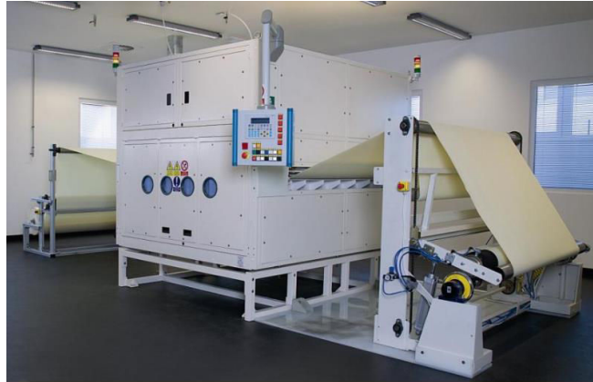
Figure 1-19 – Photo d'un procédé industriel d'électrospinning Nanospider™
