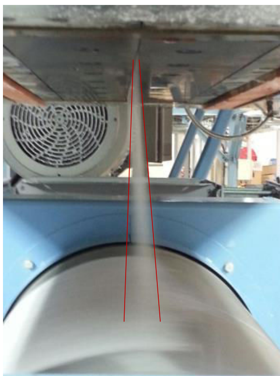
Figure 2-10 – Cône formé par les filaments en sortie de filière
