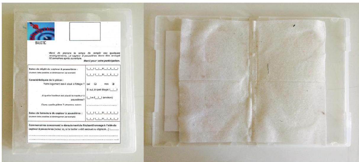
**FIGURE 11 : CAPTEUR ELECTROSTATIQUE DE POUSSIERE (EDC).**
