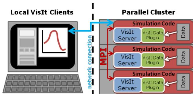
FIGURE 2.1 – Organisation de Visit en in-situ. Les serveurs Visit sont intégrés dans le code de simulation. Un client léger permet de se connecter à la simulation. <sup>2</sup>
