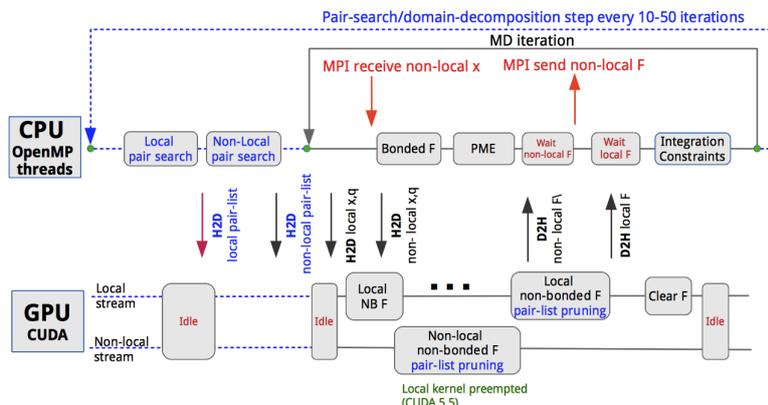
FIGURE 3.8 – Pipeline d’une itération avec support GPU. Les données sont d’abord transférées sur le GPU avant le calcul des forces non liées sur le GPU. <sup>9</sup>
