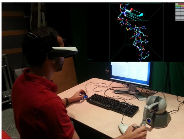
FIGURE 4.1 – Exemple d'utilisateur manipulant une simulation. Un visualiseur donne une image 3D de l'état courant de la simulation. En se basant sur cette information, l'utilisateur peut adapter le groupe d'atomes à guider ainsi que la direction et l'intensité des forces à appliquer.
