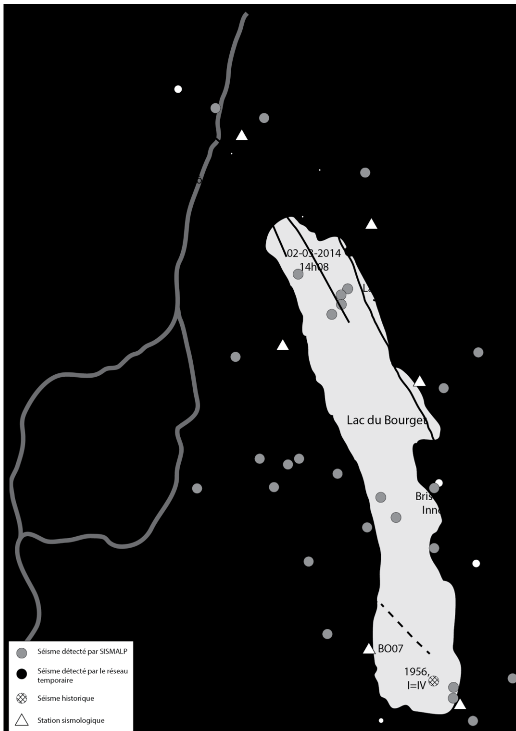
Figure IV-30 : Carte du Lac du Bourget avec les séismes détectés par les stations sismologiques temporaires et SISMALP ainsi que les séismes historiques. Le carré noir représente le forage de La Tailla (Figure IV-33). C.F. : Faille de Culoz ; C.C.F. : Faille du Col du Chat.
