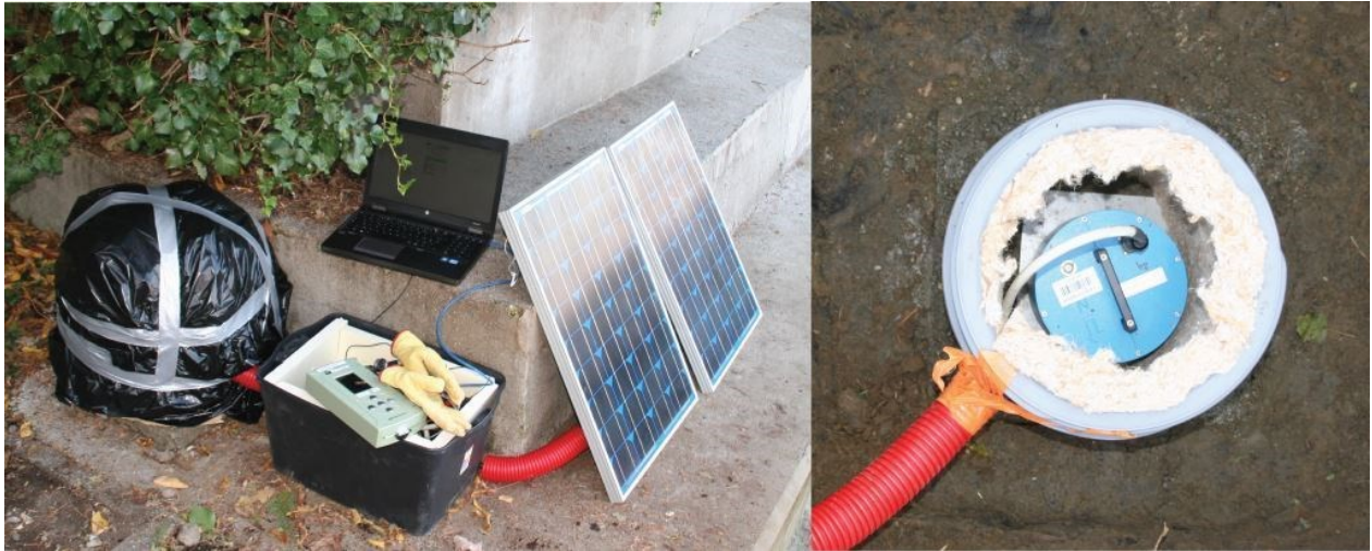
Figure II-28 : Photos d'une station sismologique composée du capteur, du numériseur ainsi que des panneaux solaires.
