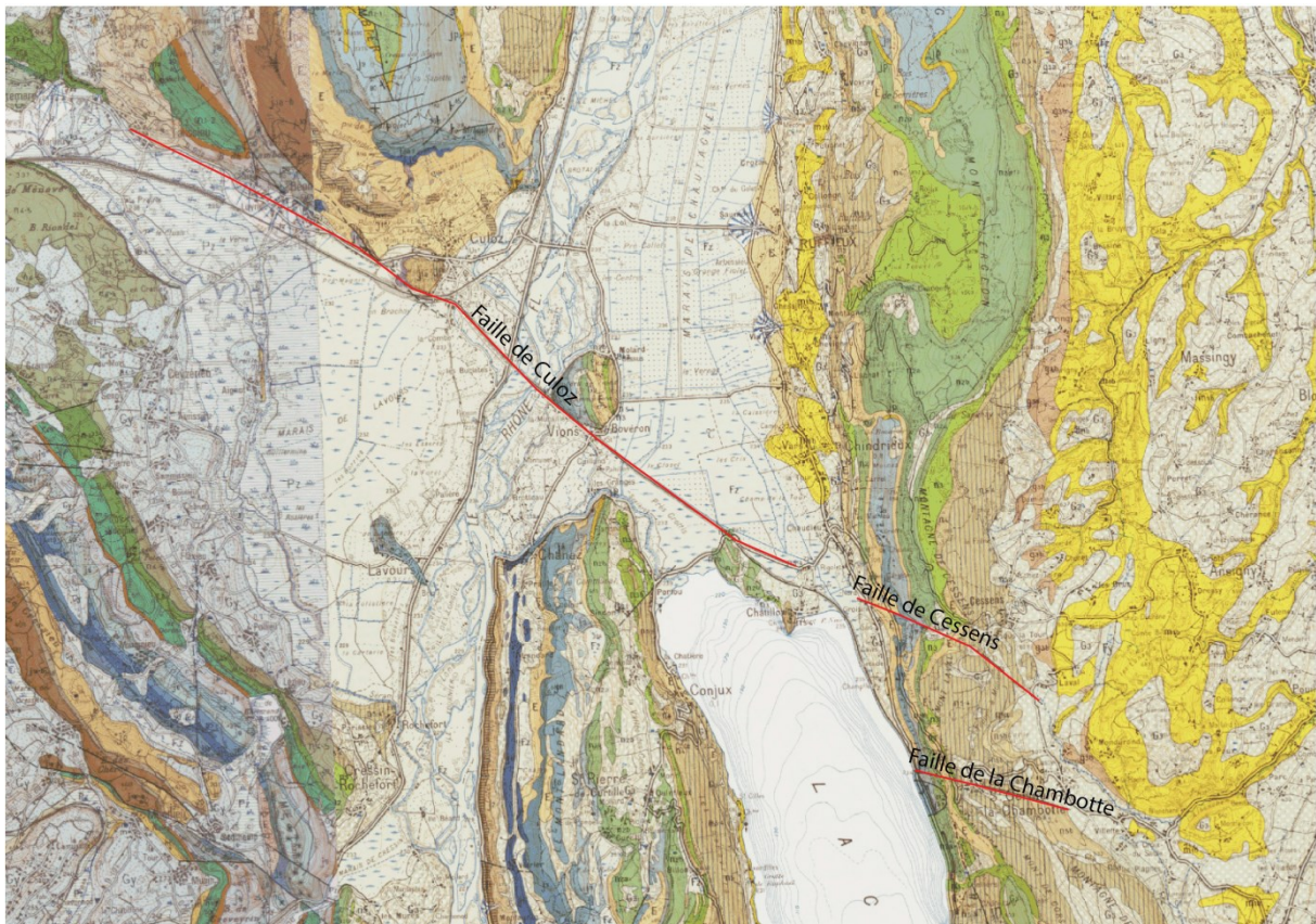
Figure I-45 : Cartes géologiques du Nord du lac du Bourget, présentant les failles de Culoz, de Cessens et de la Chambotte (Gidon et al., 1970, Kerrien et al., 1990).
