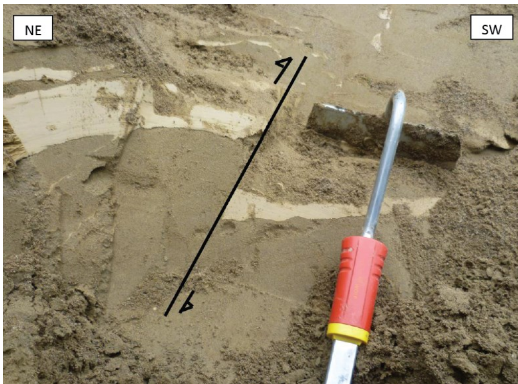
Figure III-8 : Faille inverse montrant un décalage de 7 cm du banc argileux.
