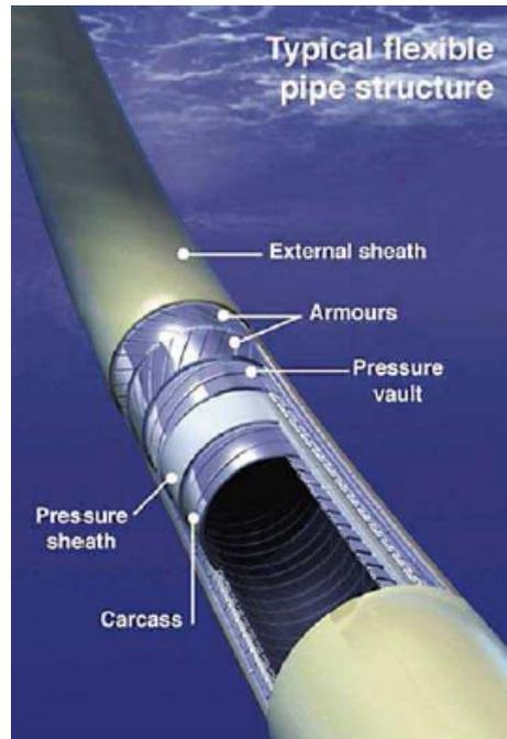
Structure d'une conduite flexible ©Technip.
