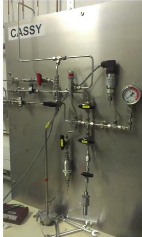
FIGURE 2.12 – Banc manuel pour cyclages d’absorption/désorption.
