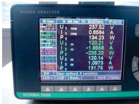
Figure 3.39. Cas d'étude pour la charge de la batterie : le PV et le réseau fournissent de la puissance vers la batterie
