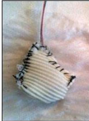
Figure 3: Enrobage d'une biopile (constituée de 2 électrodes disposées côte à côte) avec du Dacron
