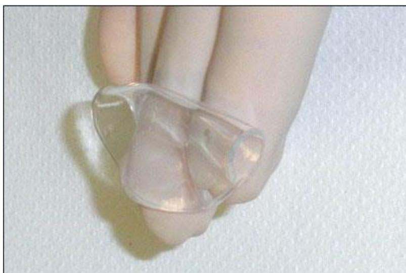
**Figure 16: Membrane en PVA (épaisseur = 1 mm ; diamètre = 3.5 mm)**
