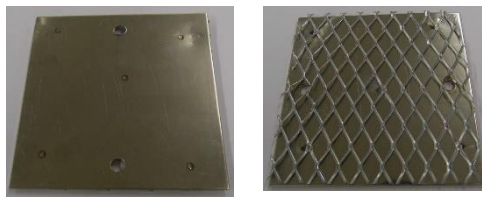
Figure 2-25 : Représentation des plaques de prélèvement de crésote lisses (gauche) et avec aspérités (droite).
