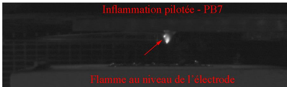
Figure 3-8 : Processus d'inflammation du cas n°2 – Flamme au niveau de l'électrode – Résidu PB7
