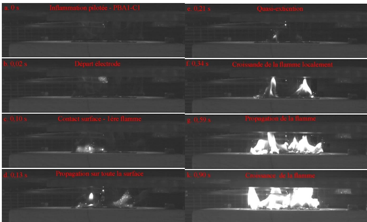
Figure 3-6 : Processus d'inflammation du cas n°2 – Croissance locale puis propagation – Résidu PBA1-C1
