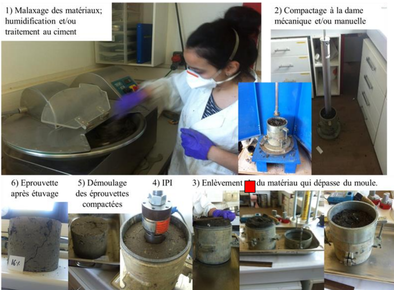
Figure 57: Les étapes d'un essai de compactage Proctor
