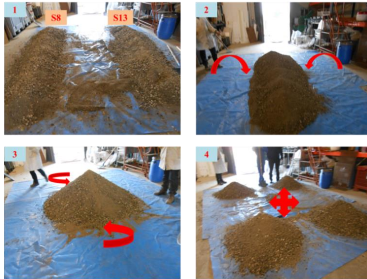
Figure 35: Les étapes d'homogénéisation des matériaux
