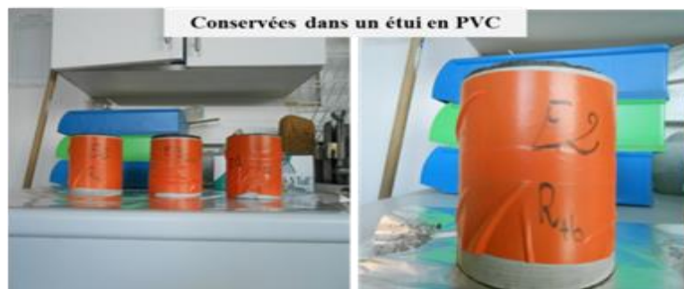
Figure 59: Éprouvettes destinées à la mesure de la résistance à la compression diamétrale
