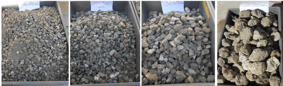
Figure 33 : Les fractions granulaires issues du criblage du matériau
