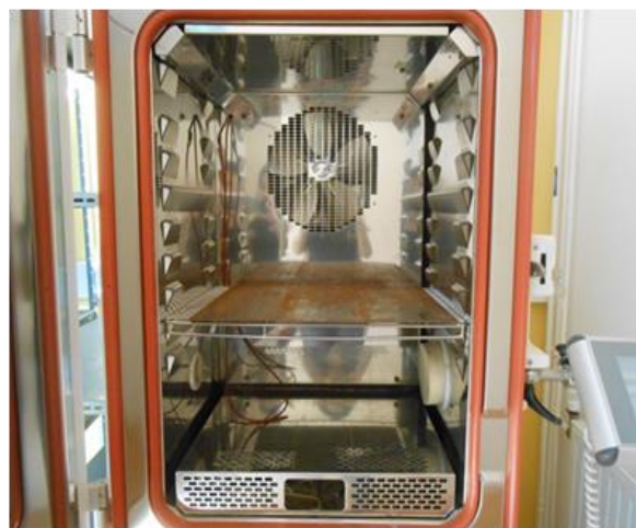
Figure 61: Photo d'une enceinte climatique
