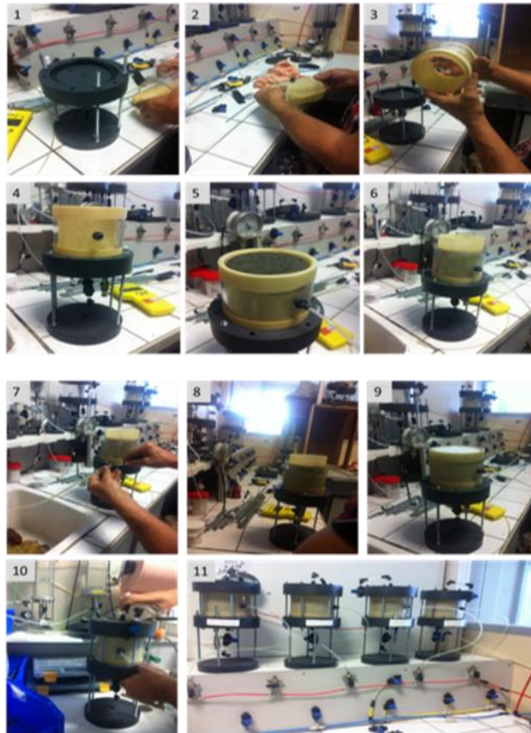
Figure 66: Mise en cellule des éprouvettes pour l'essai de percolation
