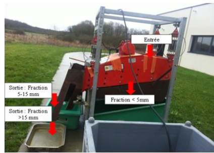
Figure 32: Organisation de l'opération de criblage du matériau d'étude
