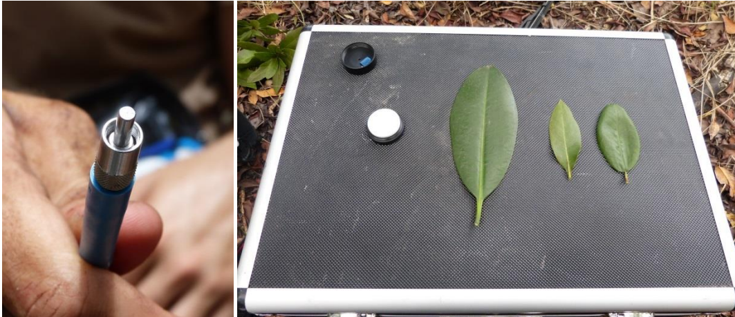
Figure 17-Utilisation d'un spectroradiomètre pour la mesure des spectres de feuilles de palétuvier. La photo de gauche montre l'objectif de la fibre optique qui capte la réflectance des feuilles, à droite la photo montre des feuilles aplanies et le spectralon permettant de calibrer le spectroradiomètre en fonction de la luminosité ambiante. © F. Taureau 2014
